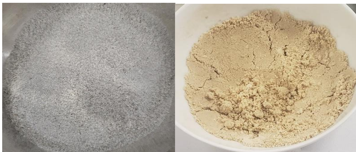
Figura 27. Materia prima despigmentada antes y después del proceso de despigmentación. Fuente. Propia.
