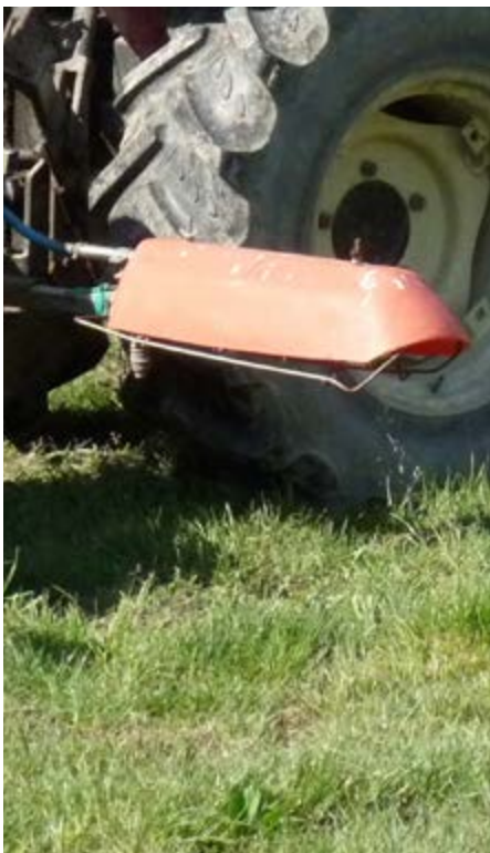
L'irroratore per diserbo (a destra) e la lama sarchiatrice montata su trattore con cingoli posteriori in gomma (a sinistra) utilizzati nelle prove
