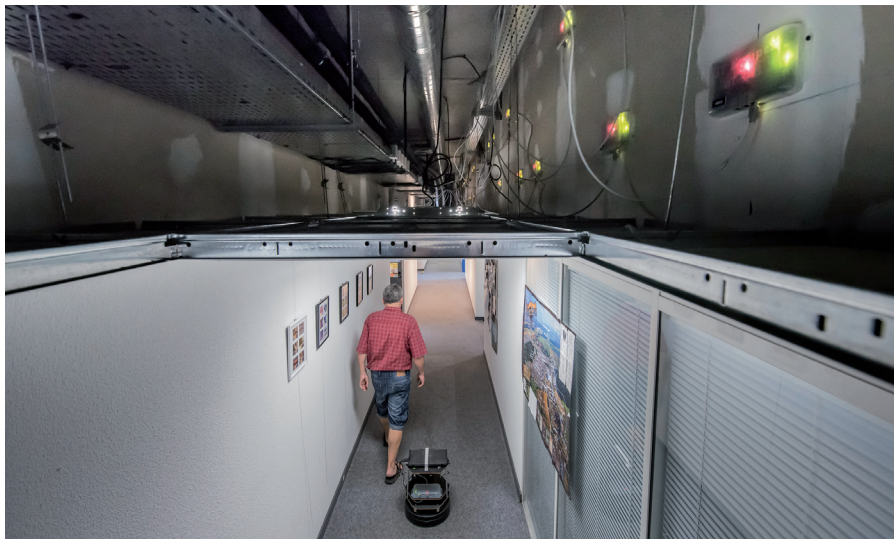
Réseau de capteurs FIT/IoT Lab installés dans le centre Inria Grenoble Rhône-Alpes. © Inria / Photo H. Raguet.
