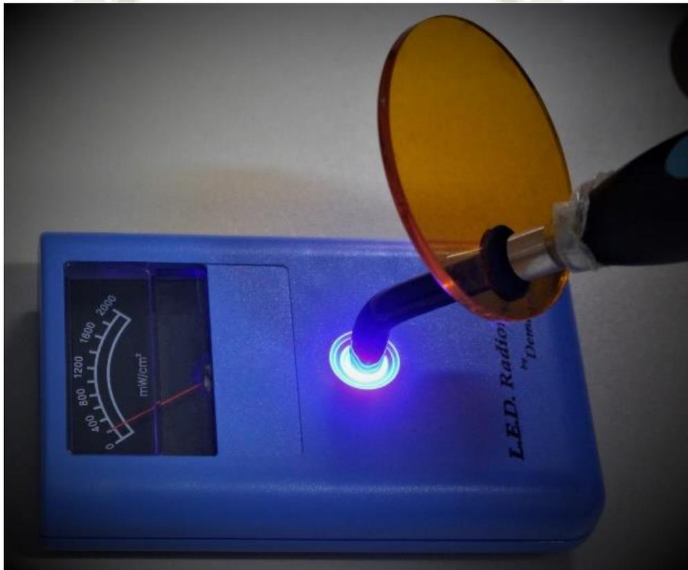
*Fotografía Nro. 1. Medida de la Intensidad de Luz. C. S. Alto Perú*
