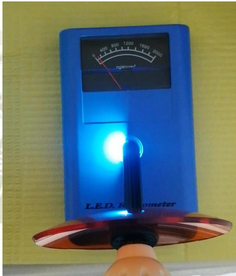
*Fotografía Nro. 5. Medida de la Intensidad de Luz. P.S. Inclán.*
