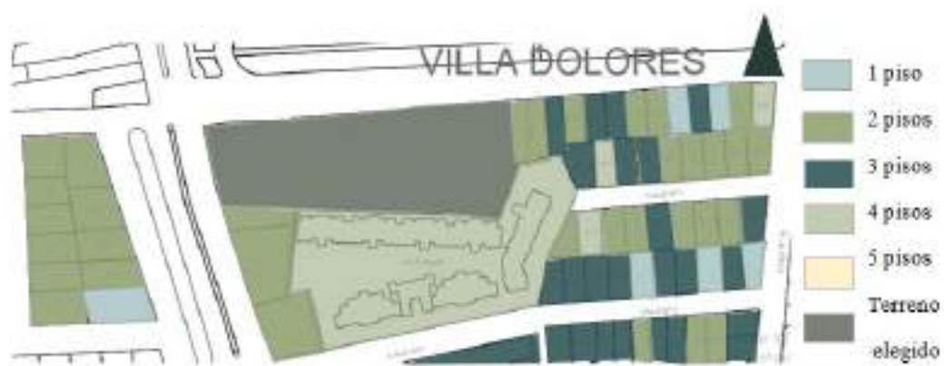
Figura 68. Esquema densidad y alturas de edificaciones
