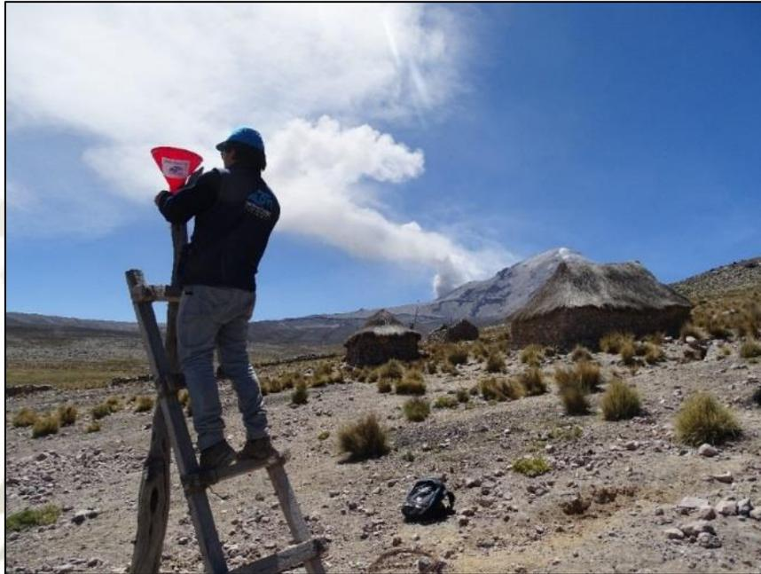
**Figura 32.** *Instalación de cenizómetros en el sector de Collpa, suroeste del volcán Sabancaya, 2017.*
