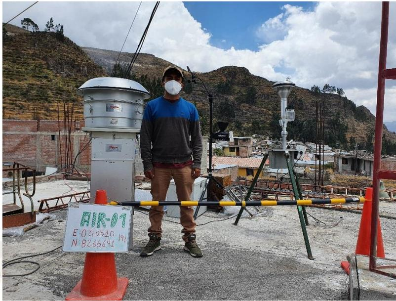
**Figura 36.** *Instalación del muestreador de alto volumen para PM10 en la Municipalidad de Achoma.*
