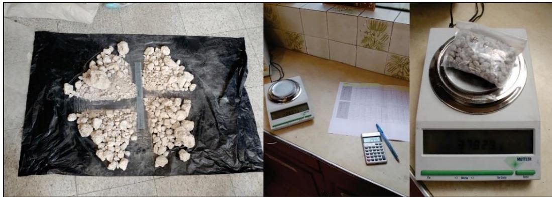
**Figura 24.** *Proceso de tamizado y cuarteo de la pómez y cenizas para posterior tratamiento granulométrico.*
