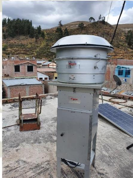
**Figura 35.** *Muestreador de alto volumen para partículas en suspensión menores a 10 micras (Hi Vol – PM 10).*
