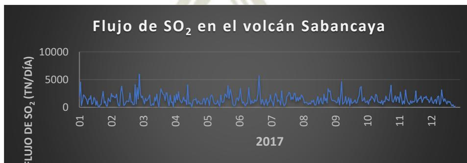
**Figura 44.** Mediciones de los flujos máximos diarios con el equipo NOVAC escáner de las lecturas diarias (color azul), registradas en la estación SADI para el monitoreo de gases de azufre SO<sub>2</sub> en la pluma volcánica del Sabancaya durante el 2017.
