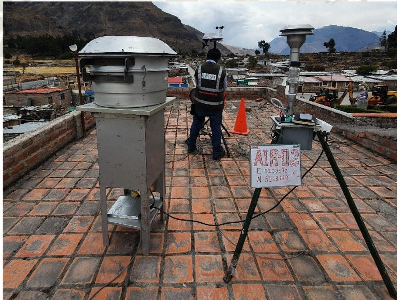
**Figura 37.** *Instalación del muestreador de alto volumen para PM10 en la Municipalidad de Maca.*
