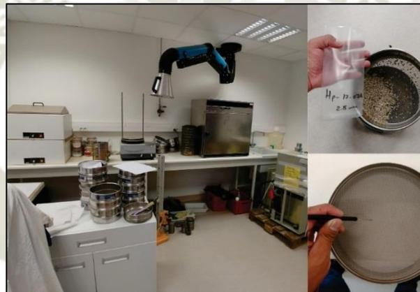
**Figura 25.** *Laboratorio de tamizaje (en Laboratorio de Geotecnia del LMV), donde se desarrolló el análisis granulométrico de las pómez del volcán Huaynaputina. Se usaron una batería de tamices y el limpiador ultrasónico.*
