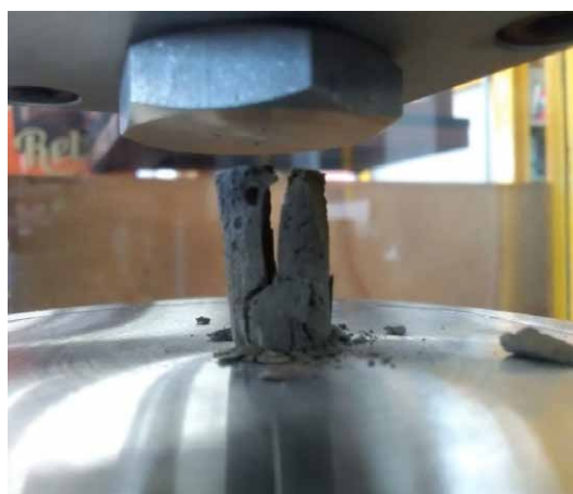
Figura 7. Muestra representativa de una probeta GPs- EC después del ensayo de compresión.
