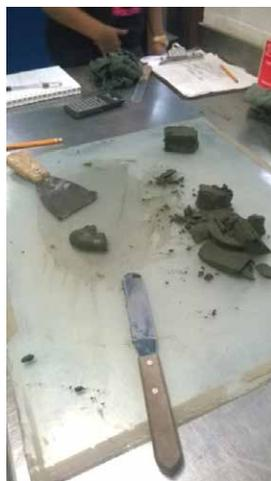
Figura 7. Remoldeo del suelo con nano-SiO<sub>2</sub>.
