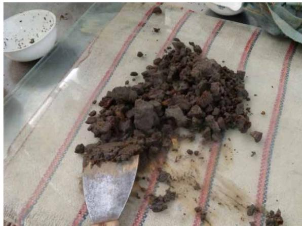
Figura 8. Muestra para determinar los límites de consistencia
