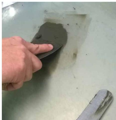
Figura 9. Preparación para determinar el Límite Líquido.
