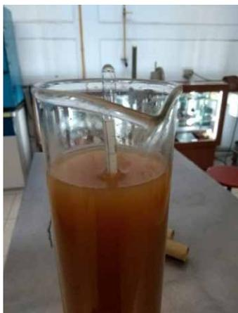
Figura 10. Hidrómetro con material que pasa la malla No. 200.
