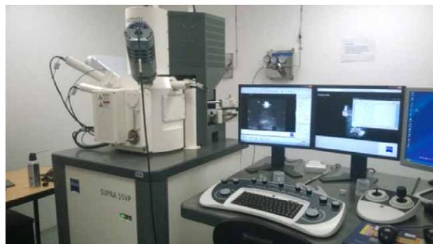
Figura 12. Microscopio Electrónico de Barrido SUPRA 55VP.
