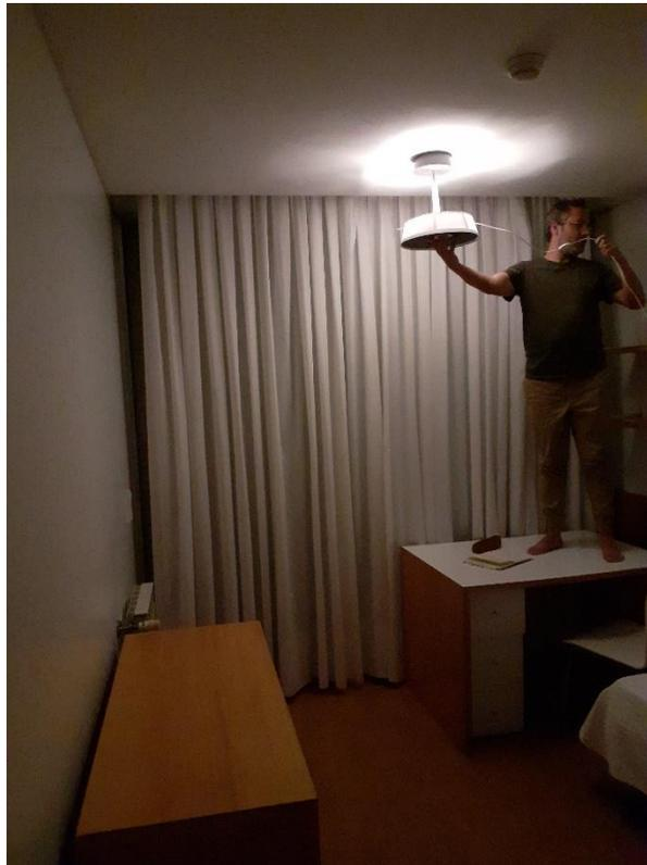
Figura 199: teste de luz satisfatório quanto à difusão da luz indireta.
