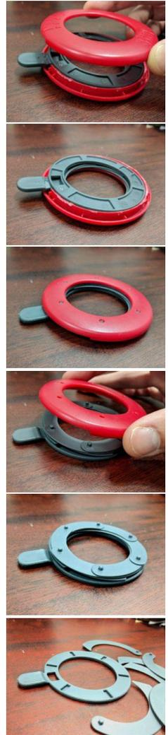
Figura 183 : passos da desmontagem do medidor.
