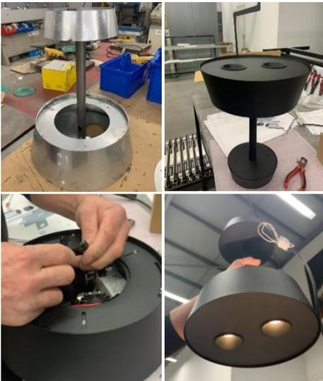
Figura 205: etapas de limpeza, pintura, eletrificação e teste de segurança.
