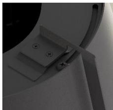
Figura 203: fixação da haste à chapa quinada com parafusos.
