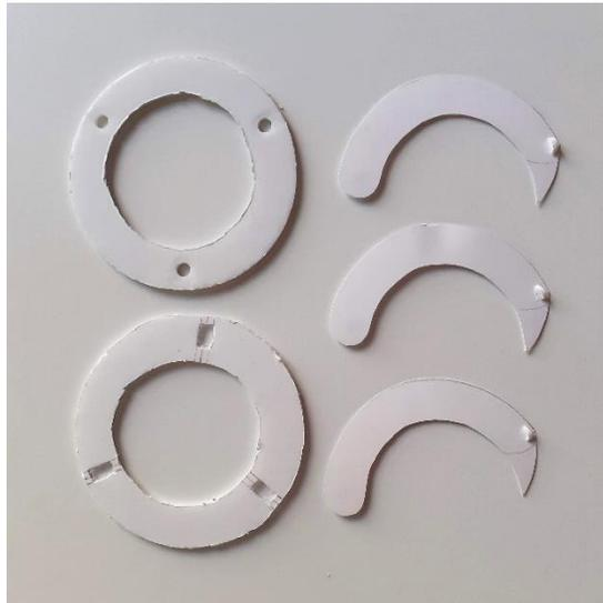
Figura 191: diafragma mecânico desmontado produzido em K-line e papel cartão.
