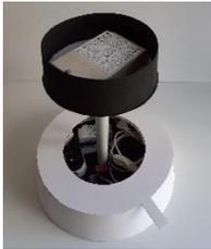
Figura 197: driver alojado na canopla no topo do candeeiro.
