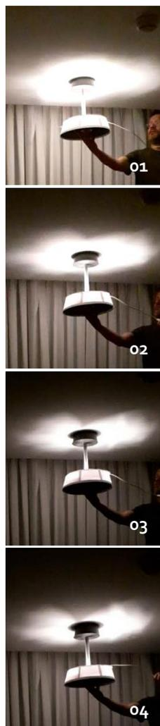
Figura 200: níveis de fechamento do diafragma com teste de luz.
