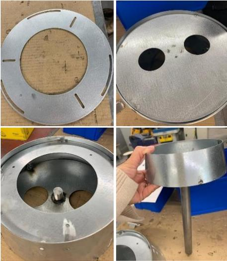
Figura 204: etapas de corte, furação e soldadura.
