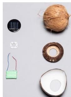
Figura 67: os demais componentes são a célula solar, o LED e a bateria.
