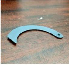
Figura 185: lâmina da íris do tipo banana.
