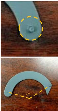
Figura 186: detalhes de localização dos pinos de encaixe e acionamento.
