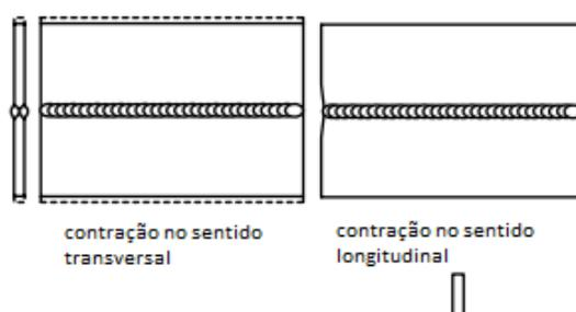
Figura 6 - Esquema dos vários tipos de distorção.
