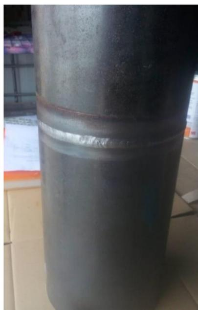
Figura 14 - Corpo de prova para o aço de baixo carbono
