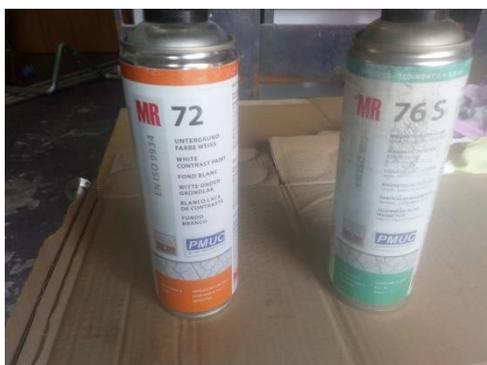
Figura 12 - Exemplo de consumíveis para o ensaio de partículas magnéticas
