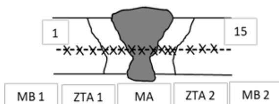
Figura 23 - Esquema das zonas de indentação do ensaio de dureza nas amostras
