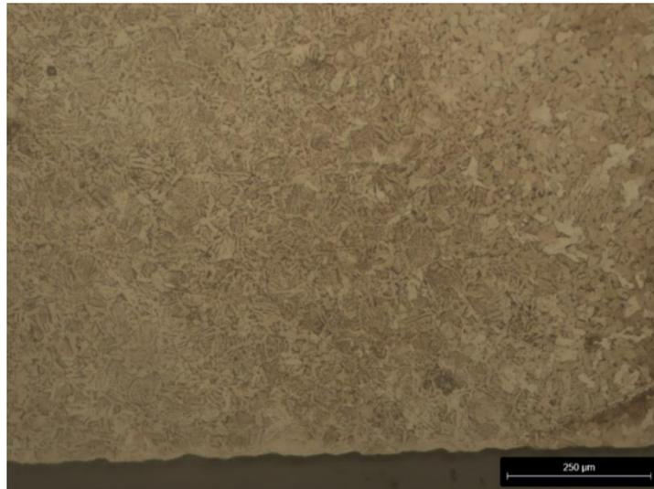
Figura 27 - Gradiente de tamanho de grão na ZTA do aço inoxidável
