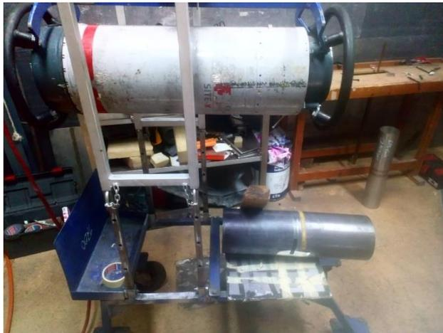
Figura 19 - Setup para a Radiografia do tubo de carbono
