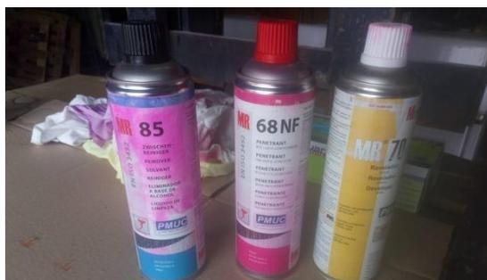
Figura 16 - Consumíveis usados no ensaio de líquidos penetrantes
