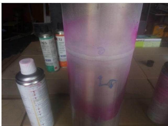
Figura 17 - Corpo de prova do aço inoxidável após o ensaio de líquidos penetrantes
