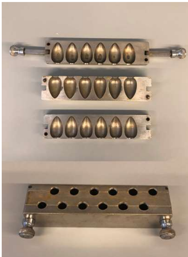
Figura 5: Exemplo de moldes metálicos usados para preparar óvulos.
