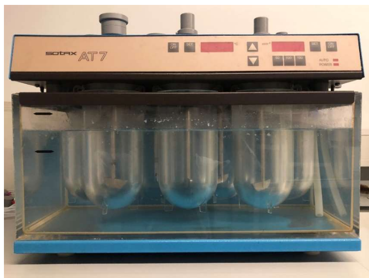
Figura 12: Aparelho de dissolução com pá agitadora.
