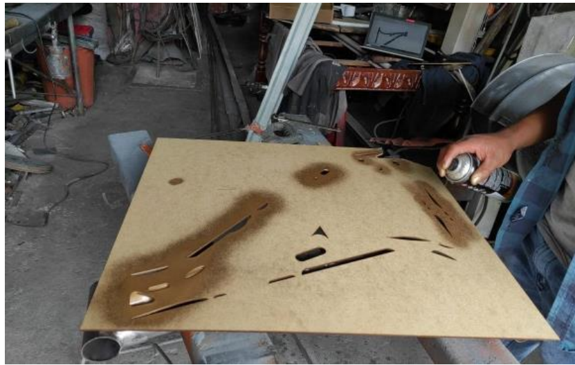
Figura 4. 12 Trazado de las areas de los diseños a ser cortados con la ayuda de una pintura en Spray.
