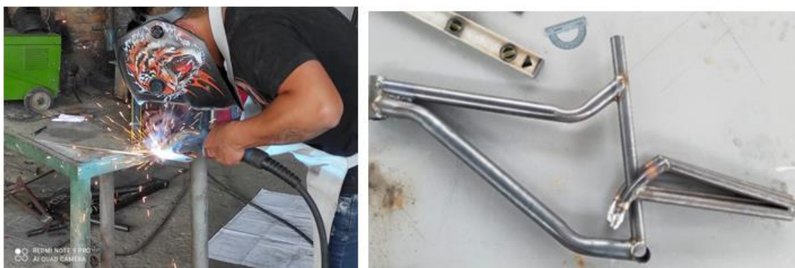
Figura 4. 5 Soldadura del marco y basculante de la bicicleta con la aplicación del proceso de suelda MIG.
