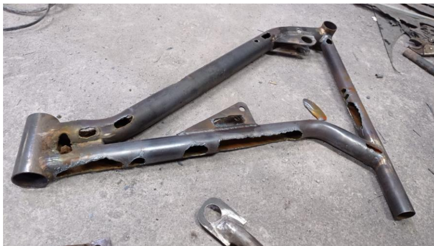
Figura 4. 15 Marco con las areas cortadas con la ayuda del plasma.
