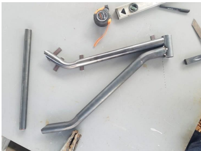
Figura 4. 4 Tubos del marco de bicicleta doblados antes de ser soldados.
