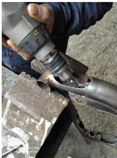
Figura 4. 17 Pulido de todas las areas cortadas.
