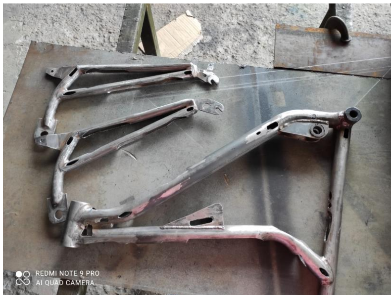
Figura 4. 18 Marco y basculante pulidos.
