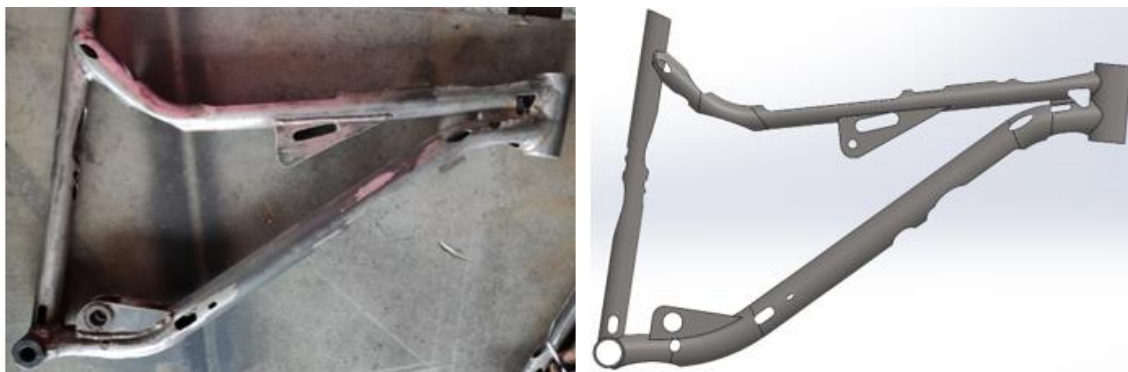
Figura 4. 21 Comparación entre el diseño en SolidWorks y el resultado del marco optimizado.
