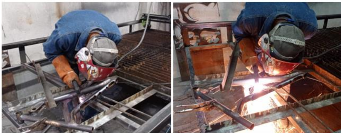
Figura 4. 14 Corte de las areas seleccionadas con el proceso de corte por plasma.
