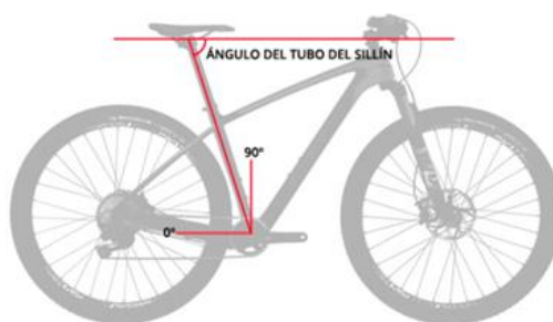
Figura 1. 14 Ángulo del tubo del sillín.
