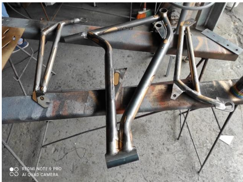
Figura 4. 13 Resaltado de todas las areas pintadas para ser cortadas.
