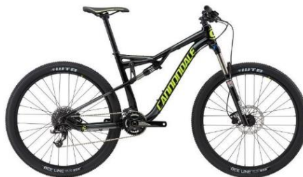
Figura 2. 1 Bicicleta integrada de un sistema de suspensión mono pivote articulado. (Rodríguez Torres 2017)
