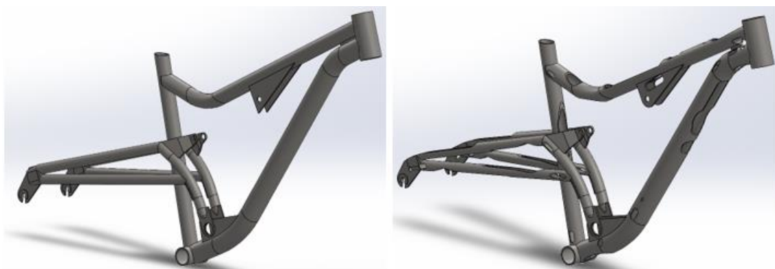
Figura 4. 1 Marco y basculante antes y después de la optimización topológica.
