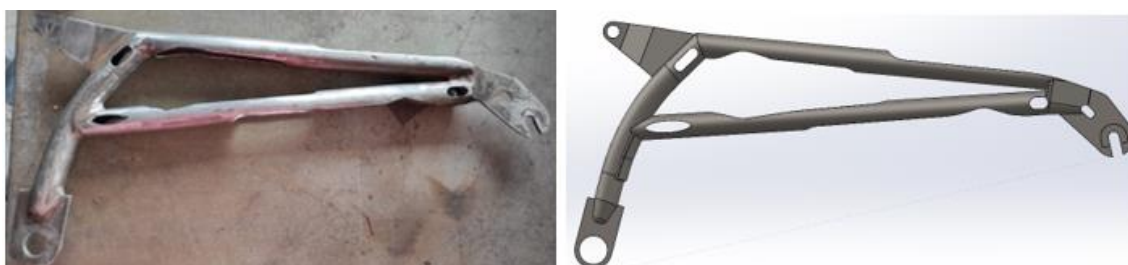
Figura 4. 22 Comparación entre el diseño en SolidWorks y el resultado del basculante optimizado.
