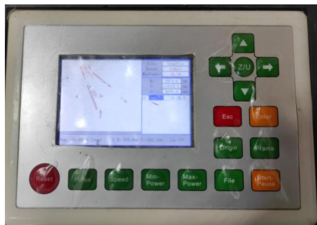
Figura 4. 11 Control computarizado de los cortes de los planos en madera para la optimización.
