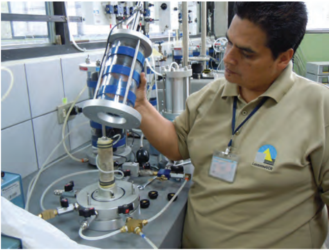
Figura 11. Colocación de cámara
