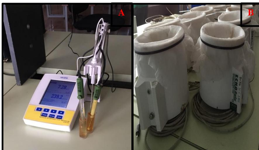
Figura 10. Instrumentos de medición A: pHmetro-conductímetro (HANNA Mod.HI98129) utilizado para las mediciones de pH y CE de solución nutritiva, drenajes y solución del sustrato y B: pluviómetros ECHO Rain (Mod. ECRN-100) para cuantificar los volúmenes de drenaje Fuente: Elaboración propia.
