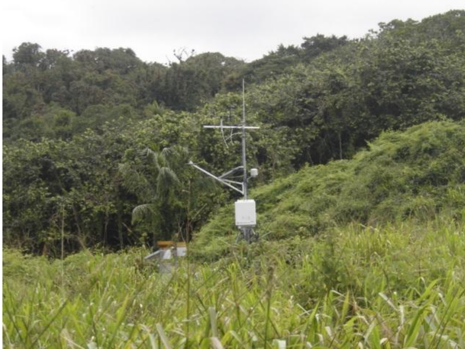
Fotografía 10. Estación automática marca Campbell, tipo CR10X, ubicada en las coordenadas: 5^{\circ}32'50.82''\text{N} , 87^{\circ}02'43.26''\text{W} , 142 msnm. La medición de las variables se realizó cada 5 minutos. Fotografía por Eric Alfaro.
