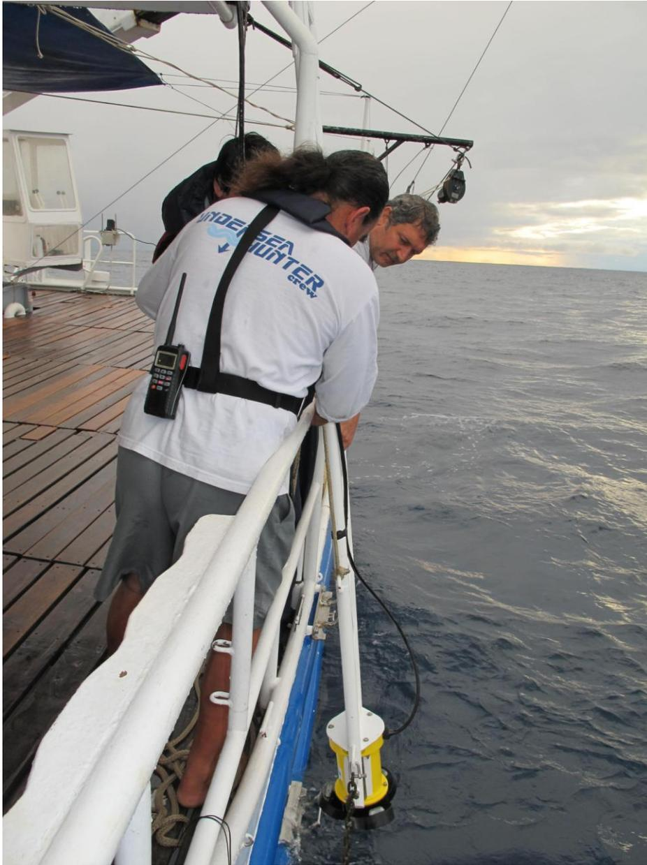
**Instalando el correntímetro acústico de efecto Doppler.**
