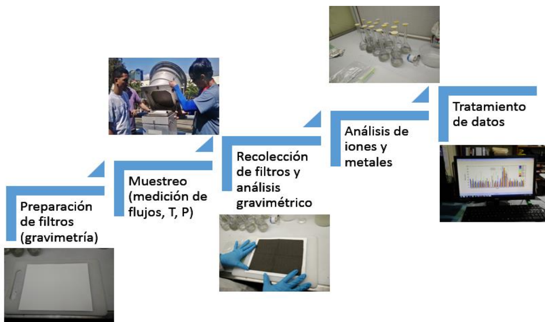
Figura 2.8 Diagrama ilustrativo del muestreo manual de partículas y sus respectivos análisis fisicoquímicos. Fuente: (propia)
