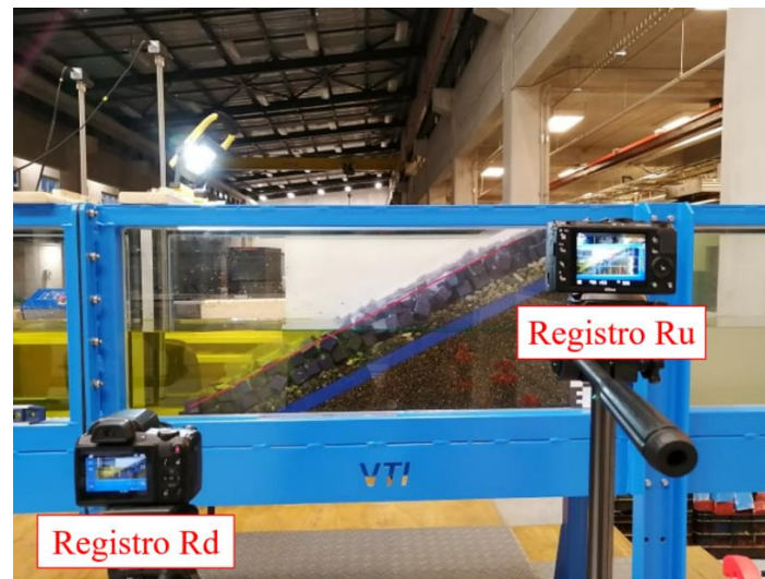
Figura 53. Colocación de las videocámaras para registro de Ru y Rd.
