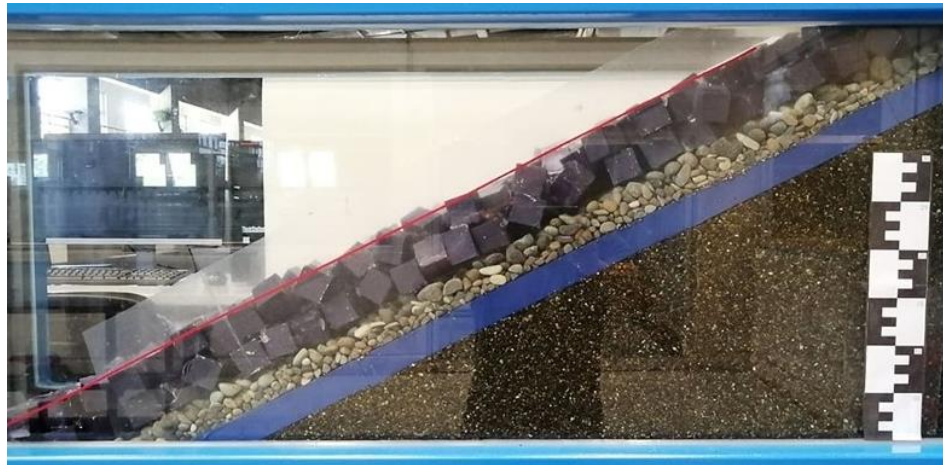
Figura 49. Fotografía de rompeolas a escala, con pendiente de talud 1 en 2.
