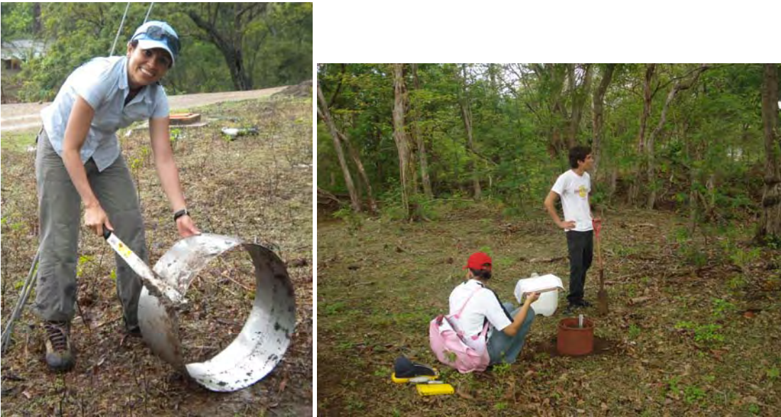
Figura -5. Trabajo de campo en la elaboración de pruebas de infiltración de doble anillo.
