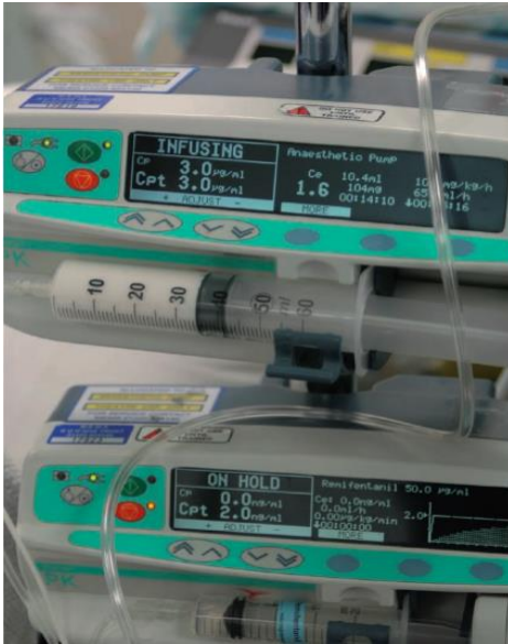
Figura 2. Programación de bombas de infusión TCI. Los errores de configuración de las bombas TCI así como, la incorrecta colocación de jeringas o dilución de fármacos, puede llevar a fallos peligrosos en la administración de TIVA. Nimmo, A. F., Absalom, A. R., Bagshaw, O., Biswas, A., Cook, T. M., Costello, A., Wiles, M. D. (2018). Guidelines for the safe practice of total intravenous anaesthesia (TIVA). Anaesthesia.
