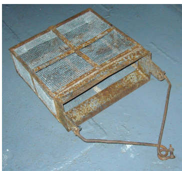
Figura 17. Rastra y draga para tomar muestras del fondo. Recogiendo la draga durante uno de los muestreos de las comunidades bénticas. Fotografías por Jeffrey Sibaja Cordero.
