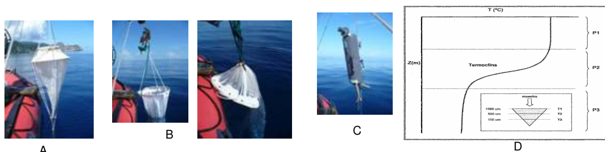
Figura 22. A) Red de fitoplancton. B) Red de zooplancton mostrando el mecanismo de cierre. C) Botella Niskin. D) Perfil de la termoclina.
