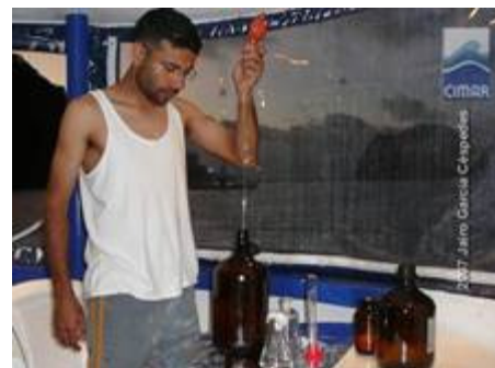
Etapas de extracción de la fase hexánica y de colocación del extracto en un frasco de vidrio para almacenarlo.
