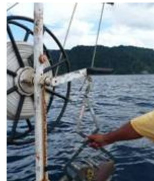
Figura 17. Rastra y draga para tomar muestras del fondo. Recogiendo la draga durante uno de los muestreos de las comunidades bénticas. Fotografías por Jeffrey Sibaja Cordero.
