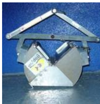
Figura 17. Rastra y draga para tomar muestras del fondo. Recogiendo la draga durante uno de los muestreos de las comunidades bénticas. Fotografías por Jeffrey Sibaja Cordero.
