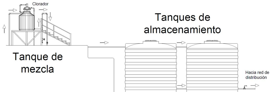
Figura 10: Cloración en el tanque de mezcla previo a los tanques de almacenamiento.
