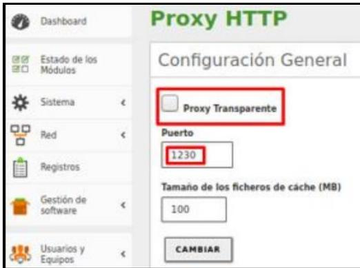
Figura 28. Configuración general del proxy
