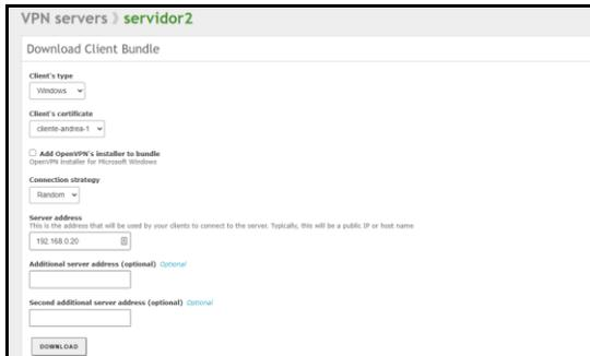
**Figura 86. Vista de Configuración de paquete de descarga para cliente VPN**
