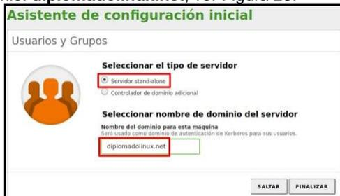
Figura 23. Configuración stand-alone
