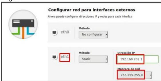
Figura 22. Configuración de ip y mascara de red
