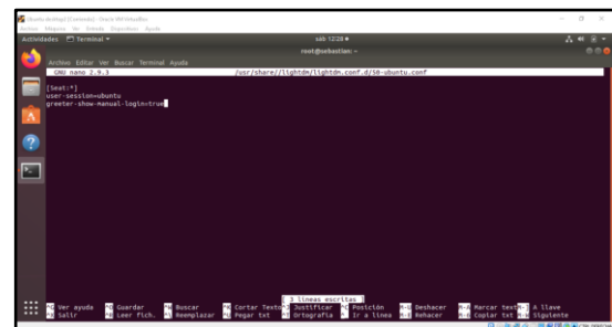
Figura 28. Activación de login a usuarios creados en el directorio del control de dominio en Zentyal.
