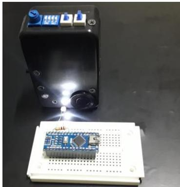
**Prueba de Señal Audible.** El usuario tiene a su disposición un interruptor que le permite activar un Buzzer el cual tiene como finalidad que las personas que estén a su alrededor adviertan de su presencia como puede ser para cruzar una calle, se realizará la activación de Buzzer por medio del su interruptor cinco veces y se registrara el resultado obtenido en la Tabla 29.
