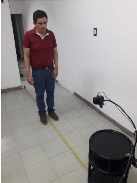
**Prueba de Desactivación de Rangos Lejanos.** El usuario del dispositivo tiene la posibilidad de desactivar la detección de obstáculos en el rango más lejano, esto para permitir al usuario del dispositivo si así lo desea no detectar los obstáculos que estén más cercanos a su presencia. Para esta prueba se desactivó la detección del rango más lejano y se evidencia que no se detecte ningún obstáculo.
