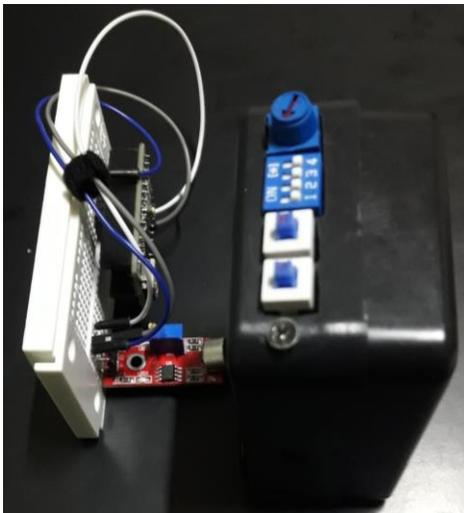
**Prueba de Señal Vibratoria.** La prueba para la señal vibratoria busca demostrar que para los rangos cercanos el motor vibrador se activa dos veces y que para los rangos lejanos el motor vibrador se activa tres veces. Para lo cual se configuró el dispositivo con los diferentes rangos de detección y se registraron los resultados en la Tabla 30.
