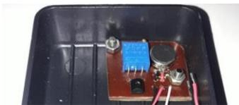
***Paso 3 Ensamble de Tarjeta del Buzzer y LED.***
