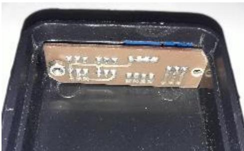
Un componente que no requiere de tarjeta PCB y que va montado directamente en la caja es el interruptor que permite al usuario encender o apagar el dispositivo, en la Figura 80 se observa su ubicación dentro de la caja.
