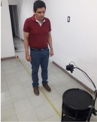
**Prueba de Distancia Máxima de Detección.** La prueba de alcance máximo de detección busca demostrar que el dispositivo es eficaz para determinar la presencia de obstáculos que estén a la distancia máxima de detección. Para lo cual se ubica una cinta métrica en el suelo como referencia y se realizan acercamientos al dispositivo para evidenciar que hay una detección del obstáculo a 200 cm, en la Tabla 25 se registran cinco detecciones y se presenta porcentualmente la exactitud del dispositivo.
