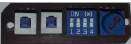
**Tarjeta de Vibrador.** La tarjeta permitirá controlar el motor vibrador por medio de un transistor lo cual fue sustentado en la etapa de diseño, en la Figura 75 se puede observar la cara posterior de la PCB y las rutas de cobre de conexión.
