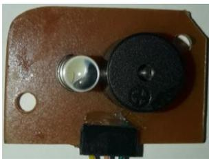
**Tarjeta de Controles de Usuario.** Como se definió en el diseño, esta tarjeta tendrá la finalidad de agrupar y asegurar los componentes que activan o desactivan las diferentes funciones del dispositivo, en la Figura 72 se pueden observar las rutas de cobre de la PCB.
