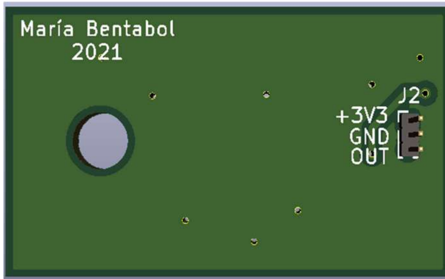
Figura 5.31: Visionado 3D placa circuito impreso de circuito de captura y acondicionamiento (cara delantera)
