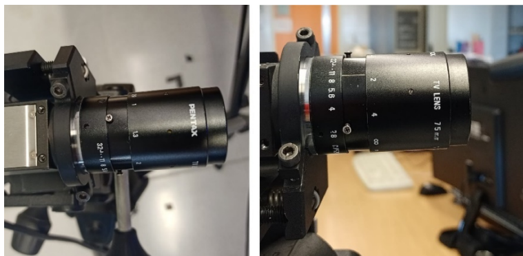
Figura 12. Objetivo de la cámara: 75 mm C-Mount Objektiv Pentax C7528-M (KP) / Ricoh FL-CC7528-2M - 2.8 / 75mm
