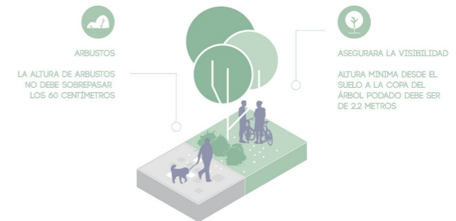
DIAGRAMA 91. LINEAMIENTOS. USOS Y ALTURAS DE LA VEGETACIÓN EN EL ESPACIO URBANO
