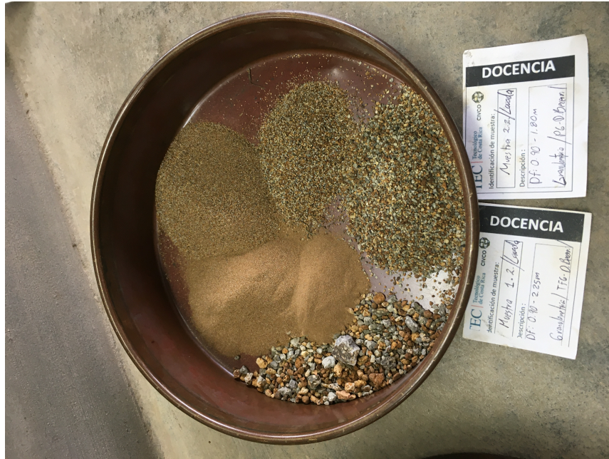
(h) Material tamizado para el estrato de suelo D_f: 0.9 - 1.8 m Fuente: Propia.
