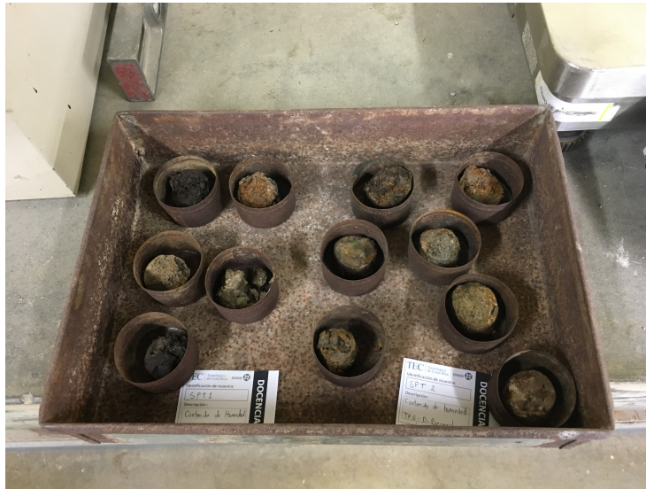
(f) Muestras secas al horno. Ensayo Contenido de Humedad
