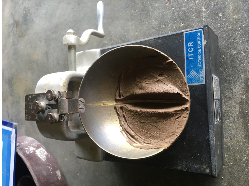
(j) Ensayo para determinar el Límite Líquido por método Casagrande Fuente: Propia.
