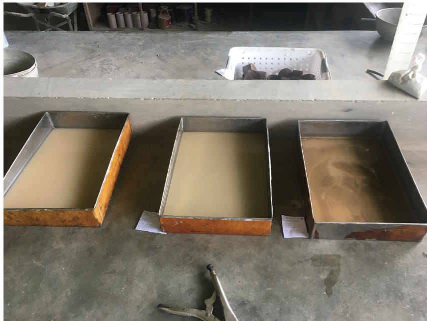
(i) Muestras secando para Ensayo de Límites de Atterberg. Fuente: Propia.
