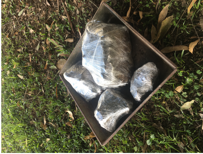
(b) Sellado de muestra 1 para llevar a laboratorio Fuente: Propia, con ayuda de un técnico del CIVCO
