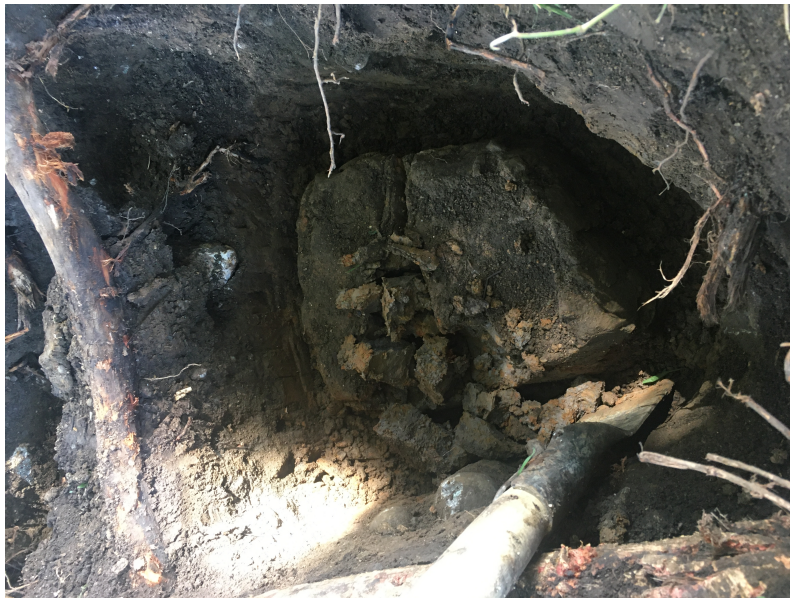
(a) Extracción de bloque 1 inalterado
