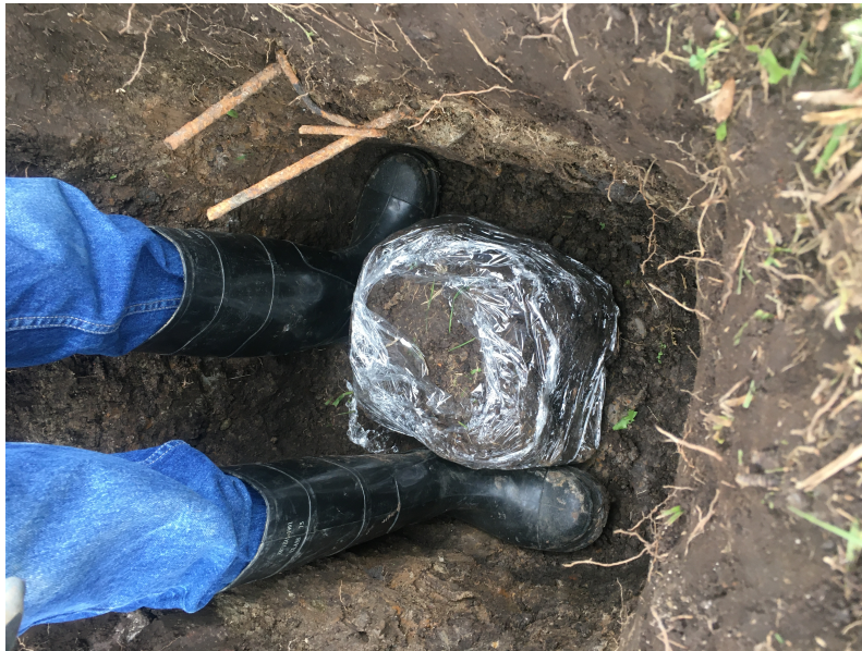
(c) Sellado de muestra 2 para llevar a laboratorio Fuente: Propia, con ayuda de un técnico del CIVCO
