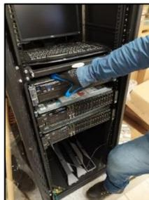
**Figura 21.** Servidores del Sistema de Control
