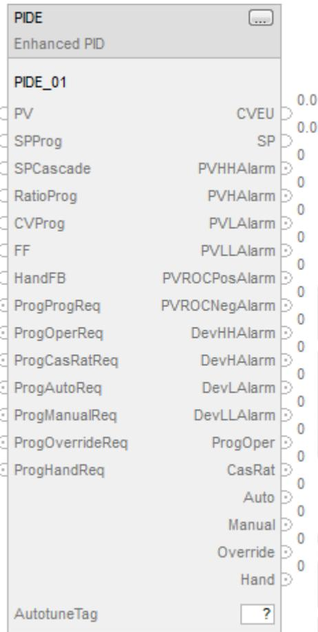
Figura 3-14 – Bloque de Control PIDE
