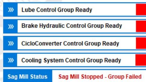
Figura 3-23 – Indicación “FAIL” de Estado de Grupos de Molino SAG
