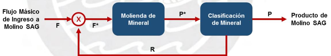
Figura 2-5 – Diagrama de Etapas de Connición de Molino SAG
