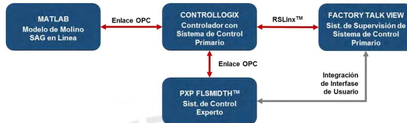
Figura 1-7 – Bloques de Comunicación de Sistema de Control.
