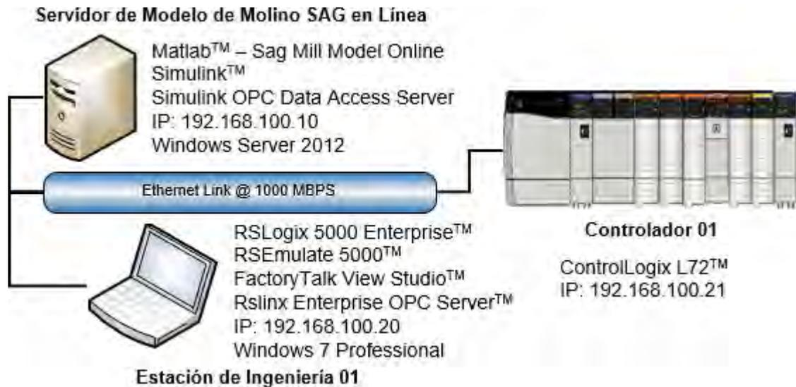
Figura 3-19 – Arquitectura de Comunicación entre Simulink y RSLogix 5000™
