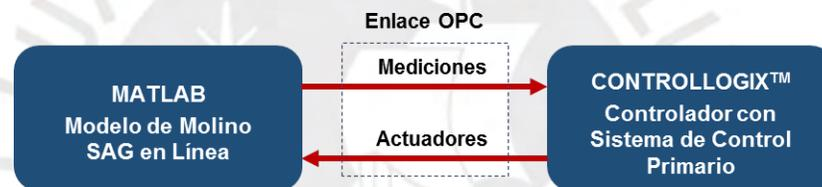
Figura 2-11 – Enlace de Comunicación de Modelo Matemático en Línea.
