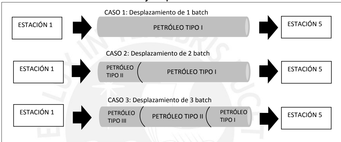
Gráfico N° 11. Distribución y desplazamiento de batches en el ducto
