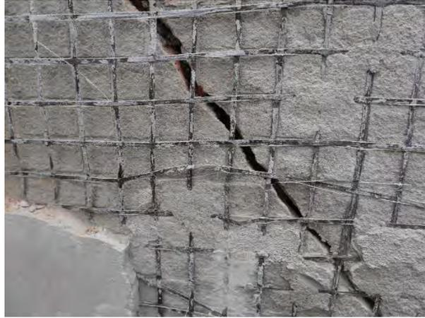
**Figura 6-36. Deformación de malla de MB-2.**
