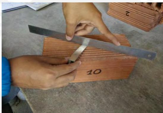
Figura 4-4. Colocación de cuña sobre punto de flecha máxima en unidad cóncava (Díaz y Cevallos, 2018).
