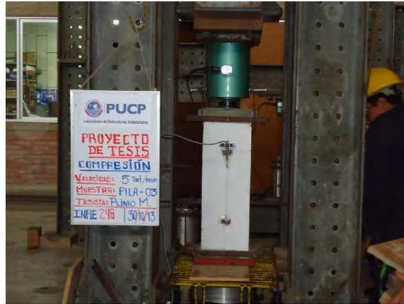
Figura 3-3. Ensayo de compresión axial en pilas de albañilería. (Mamani, 2015).
