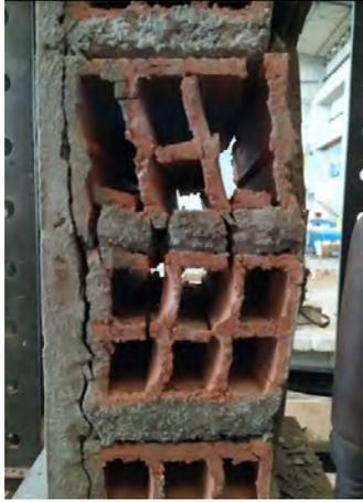
Figura 6-11. Falla pila PE-2.
