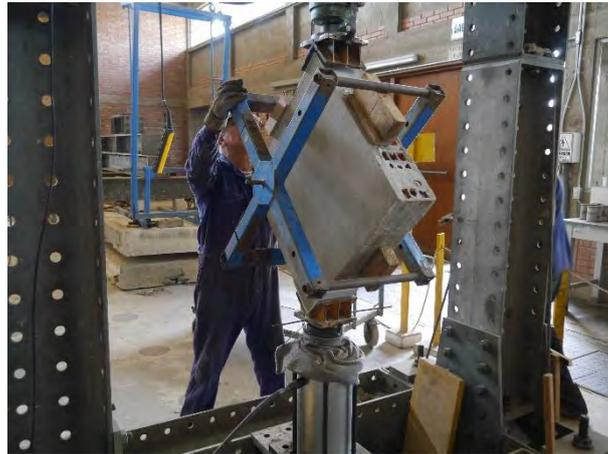
Figura 6-20. Preparación de ensayos de compresión diagonal.
