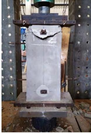
Figura 6-16. Ensayo de compresión de pila PB-2.
