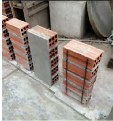
**Figura 5-3. Pila reforzada con malla electrosoldada.**
