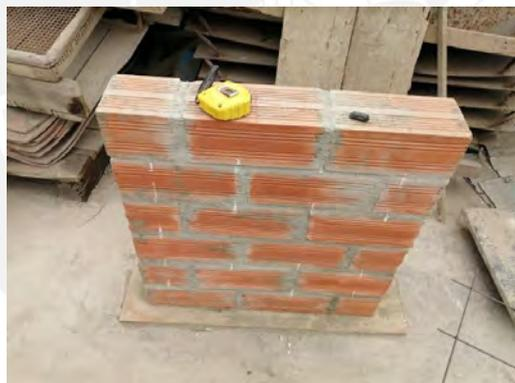
**Figura 5-8. Puntos a perforar en murete para refuerzo con M.E.**
