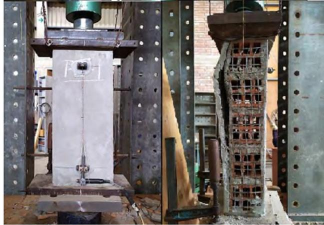
Figura 6-14. Ensayo de compresión de pila PB-1.
