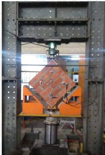
Figura 3-4. Ensayo de compresión diagonal en murete de albañilería.
