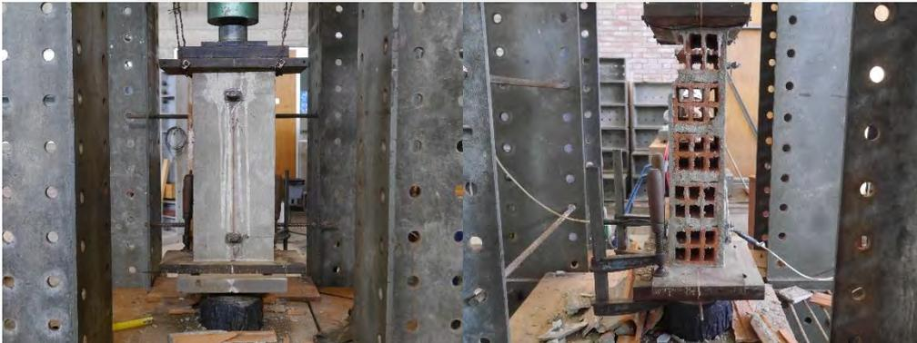
**Figura 6-6. Ensayo de compresión de Pila P-3.**
