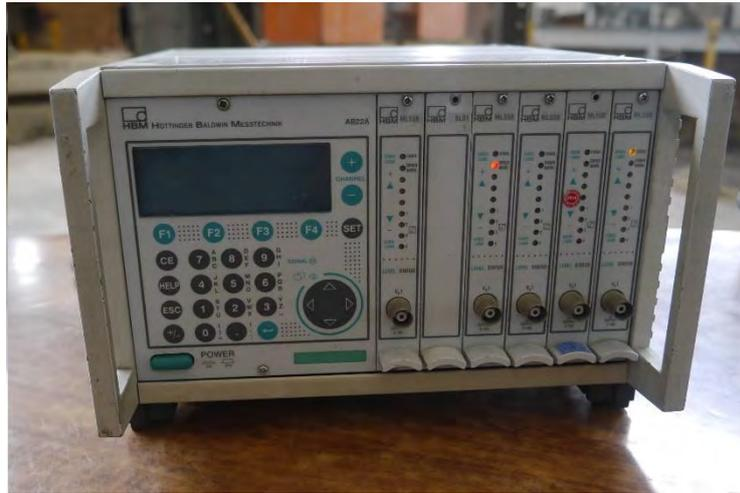
Figura 6-22. Amplificador de señales HBM.
