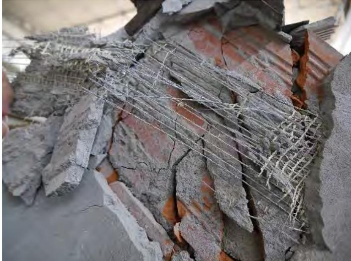
Figura 6-41. Fibras de acero tensas con desprendimiento de polímero.
