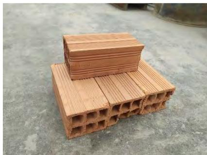
Figura 4-1. Unidades de albañilería tubular
