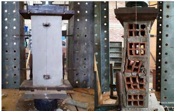
**Figura 6-10. Ensayo de compresión de pila PE-2.**
