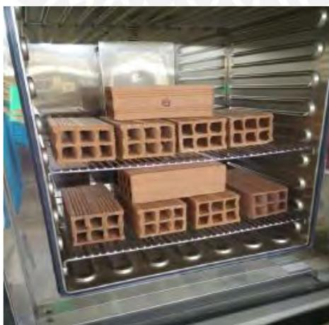
Figura 4-6. Ensayo de absorción (Díaz y Cevallos, 2018).
