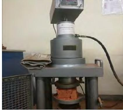
Figura 4-3. Ensayo de compresión simple (Hernández et al, 2018).
