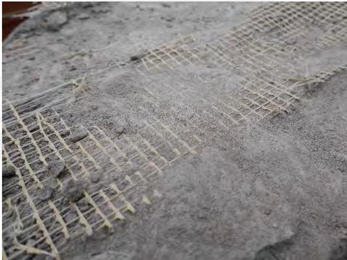
Figura 6-42. Banda de fibra de acero adherida a mortero.
