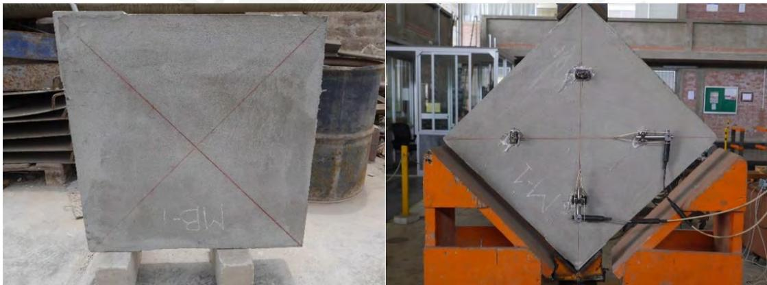
Figura 6-21. Ejes y colocación de dispositivos LVDT en diagonales.
