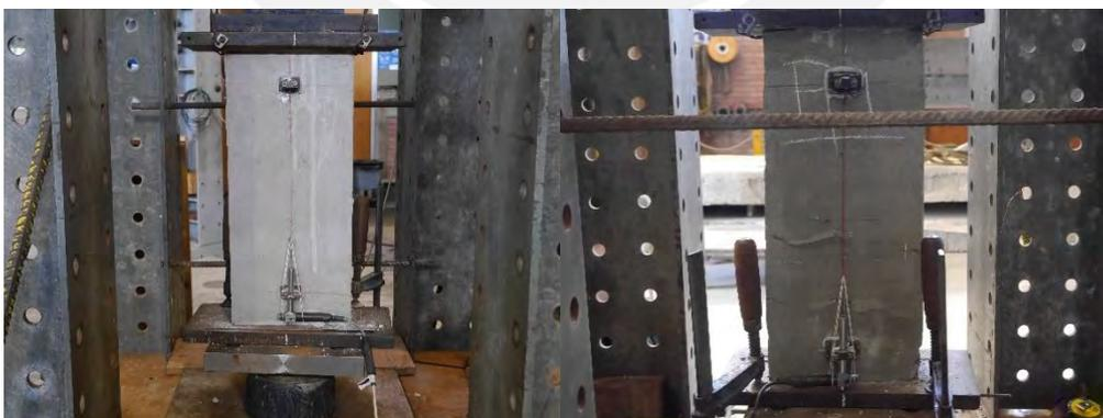
Figura 6-2. Ensayo de compresión de pila P-1
