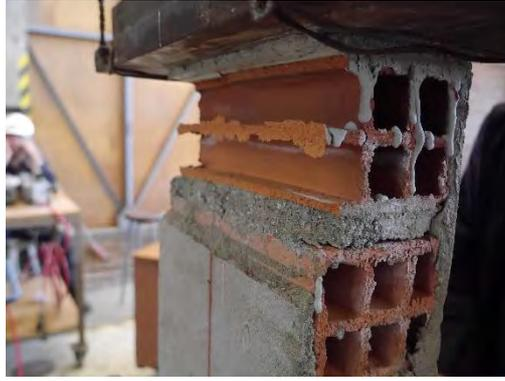
Figura 6-7. Falla de pila P-3.
