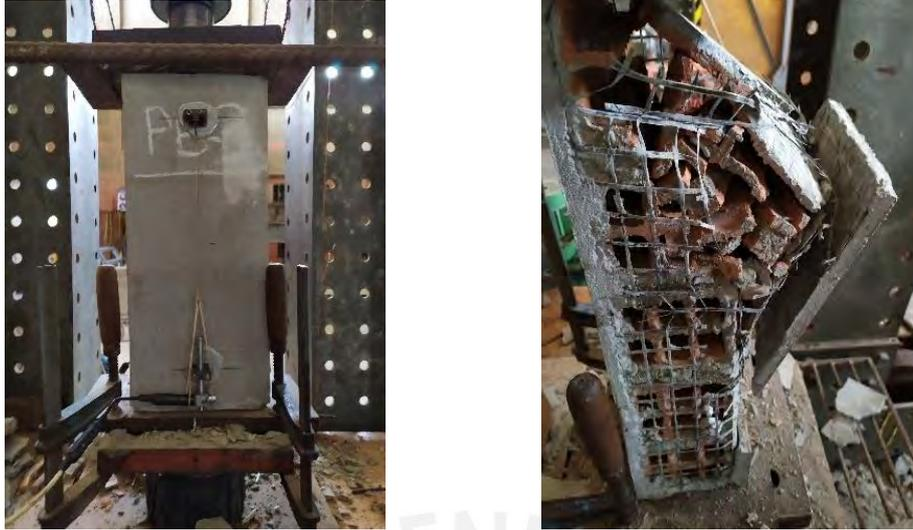
Figura 6-18. Ensayo de compresión de pila PB-3.
