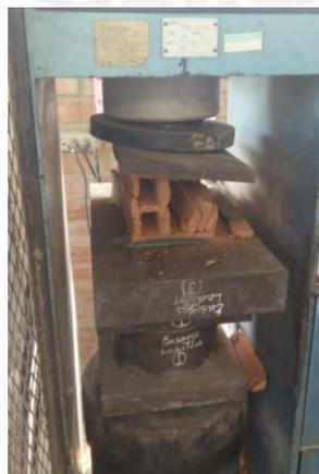
Figura 4-2. Ensayo de compresión simple (Díaz y Cevallos 2018).
