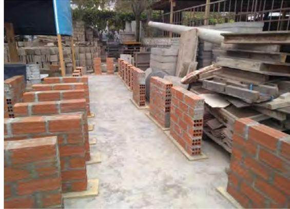
**Figura 5-7. Muretes de albañilería confinada a ser reforzados.**
