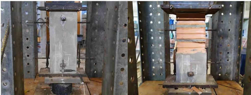
**Figura 6-4. Ensayo de compresión de pila P-2.**
