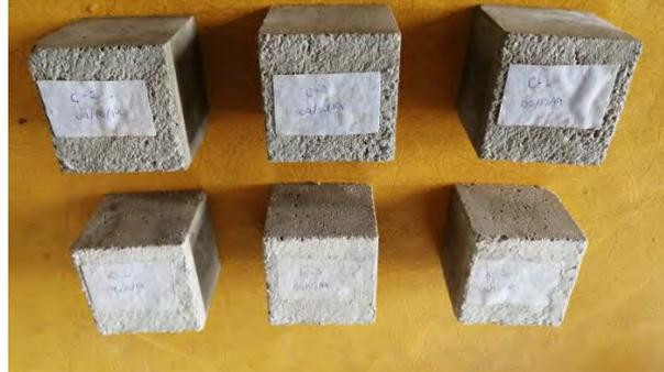
**Figura 4-11. Probetas de mortero (arriba: Cemento-Cal; abajo: Kerakoll).**
