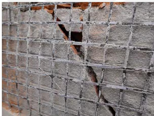
**Figura 6-35. Detalla de falla de MB-2.**
