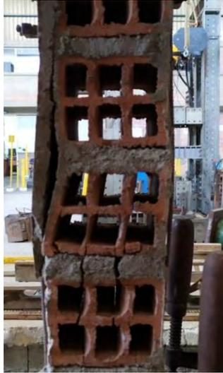
Figura 6-13. Falla de pila PE-3.
