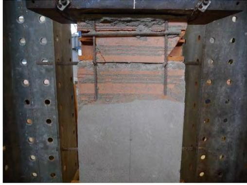
**Figura 6-9. Falla pila PE-1.**
