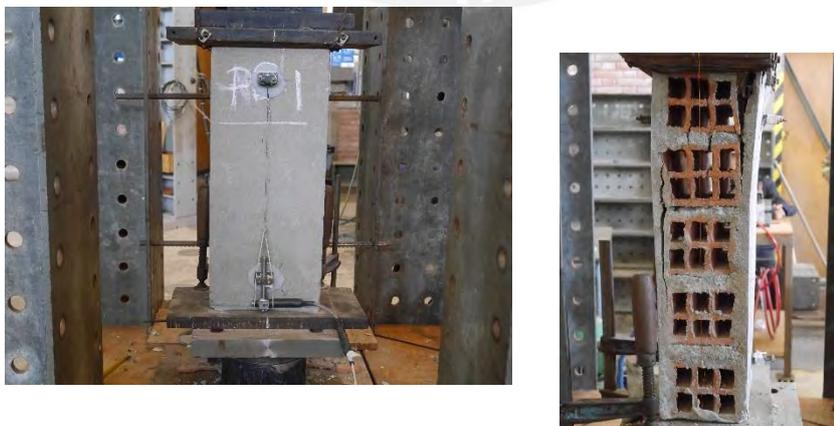
Figura 6-8. Ensayo de compresión pila PE-1.
