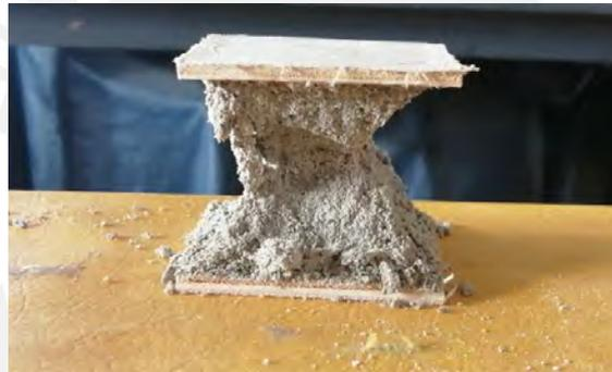
**Figura 4-12. Falla trapecoidal de mortero C-2.**
