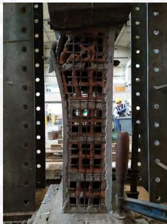
Figura 6-17. Falla local en pila PB-2.
