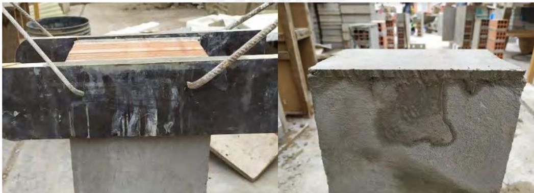
Figura 6-1. Colocación de capping en las pilas de albañilería tubular.
