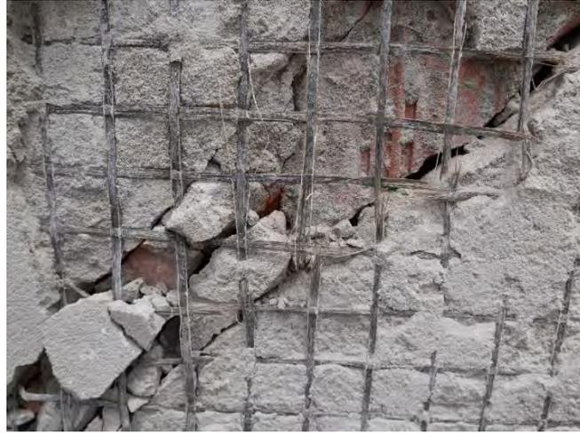
Figura 6-38. Rotura de malla durante ensayo de MB-3.
