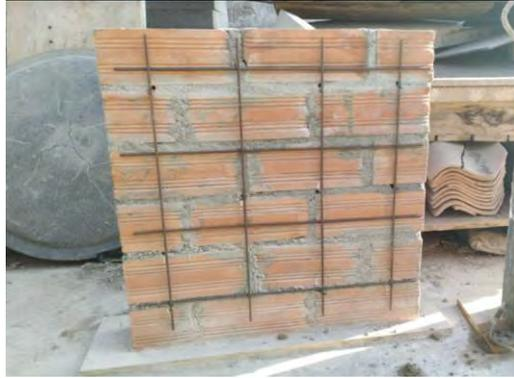
**Figura 5-9. Murete reforzado con malla electrosoldada.**
