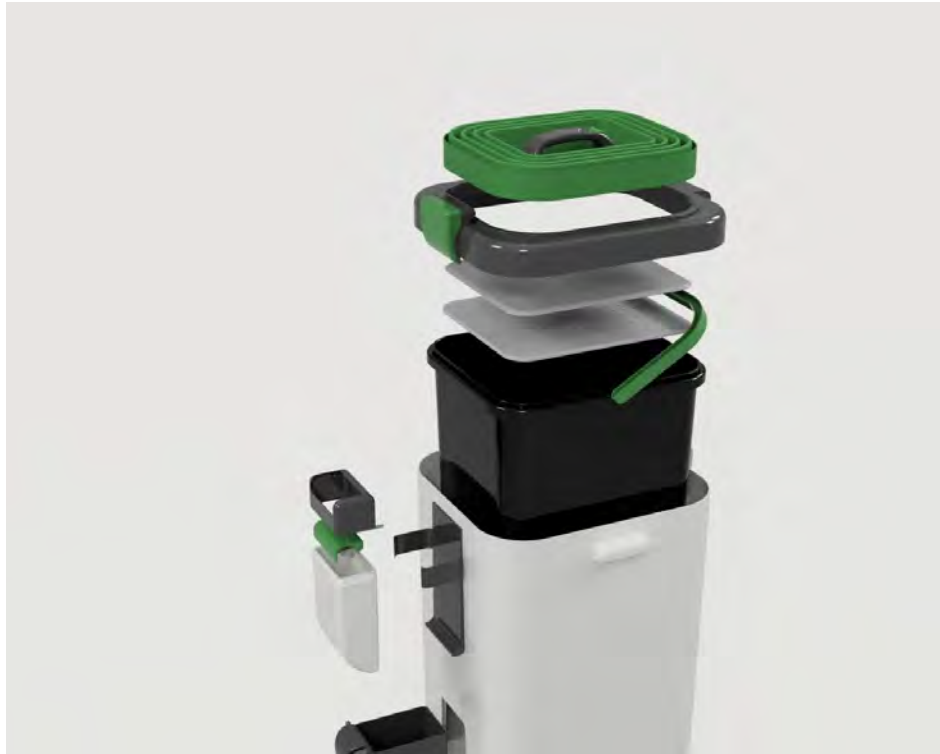
Figura 13: Vista explosiva de contenedor de residuos orgánicos
