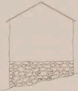
Uso de pircas para nivelar la pendiente
