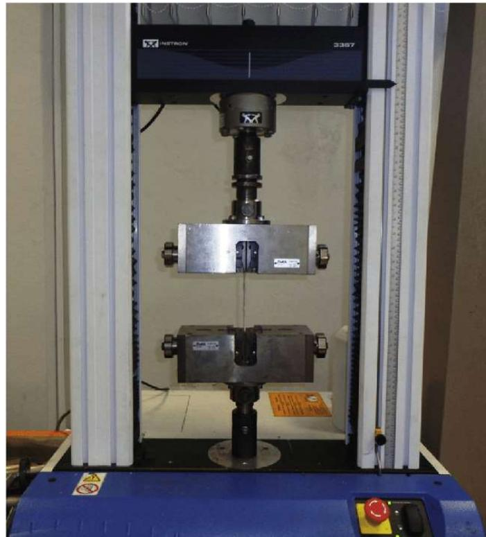
Figura 2 - Instron-3367 máquina de ensaio de tensão.
