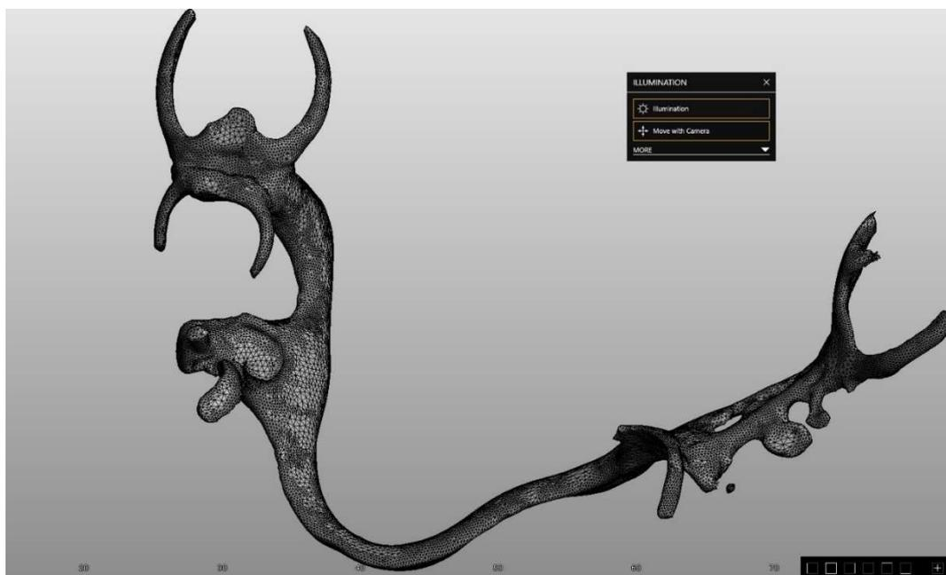
Figura 10 - Elemento finito de Prótese esquelética removível. Software de modelação ZIRKONZHAN.MODELLIER
