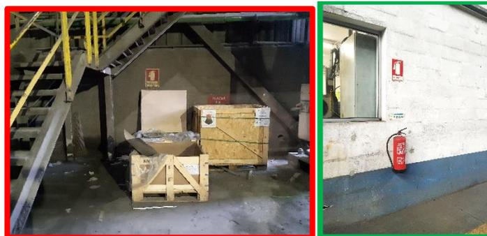
**Figura 7:** Condição insegura vs. Condição segura- Equipamento de combate a incêndio.
