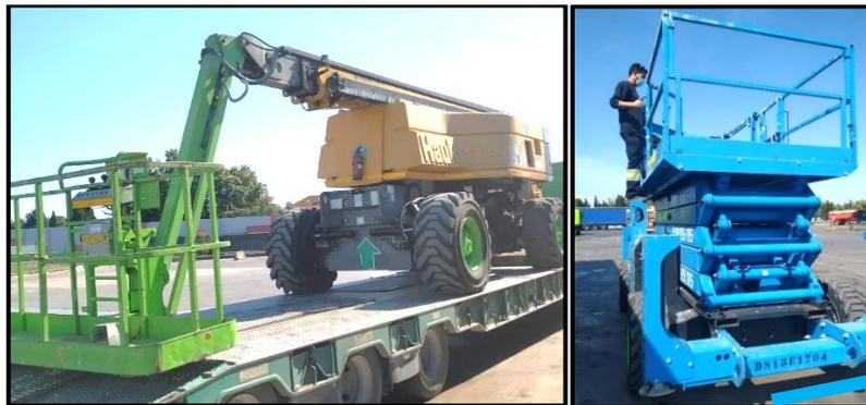
**Figura 25:** Plataforma elevatória telescópio e Plataforma elevatória tesoura.
