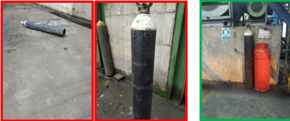
**Figura 10:** Condição insegura vs. Condição segura- Garrafas de gás.
