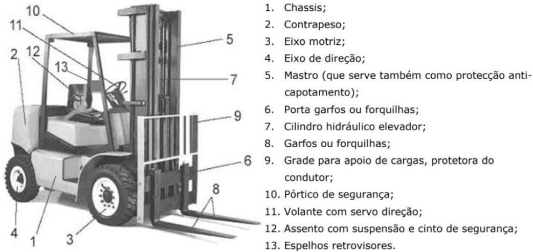
**Figura 20:** Legenda dos componentes de empilhador.
