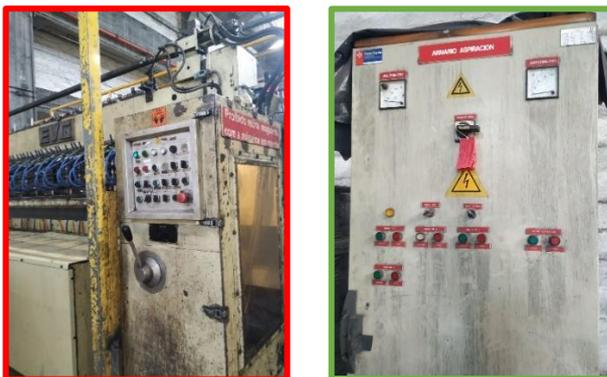
**Figura 12:** Condição insegura vs. Condição segura- Bloqueios.
