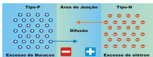
Figura 2 – Ilustração do Efeito fotovoltaico (fonte: [3])
