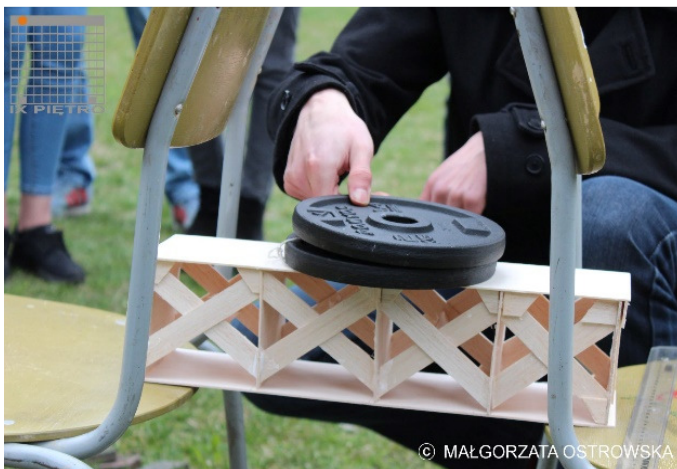
Rys. 6. Obciążanie gotowych makiet mostów; (fot. Małgorzata Ostrowska)
