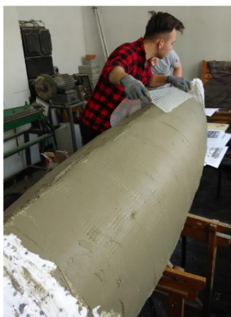
Rys. 3. Wzmacnianie konstrukcji formy – nakładanie siatki podtylnkowej
