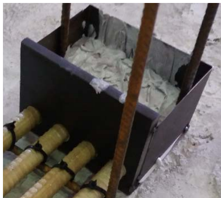
Rys. 2.1. Zakotwienie prętów GFRP (po lewej stronie) oraz stalowych (po prawej stronie) Fig. 2.1. Anchorage of GFRP (left) and steel bars (right)
