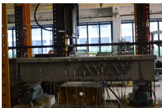
Rys. 2.8. Widok stanowiska badawczego: strona monitorowana systemem Aramis (z prawej strony) oraz strona monitorowana czujnikami LVDT (z lewej strony)
