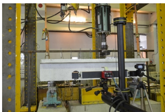
Rys. 2.8. Widok stanowiska badawczego: strona monitorowana systemem Aramis (z prawej strony) oraz strona monitorowana czujnikami LVDT (z lewej strony)
