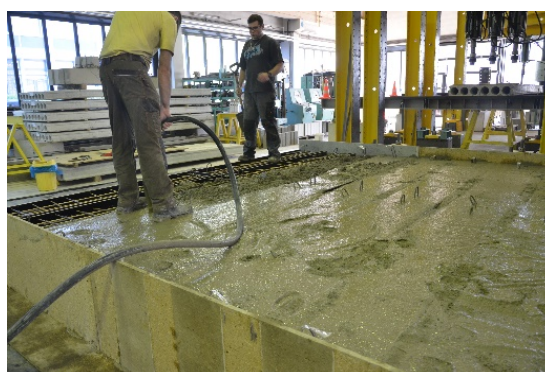
Rys. 2.7. Betonowanie belek Fig. 2.7. Casting of beams
