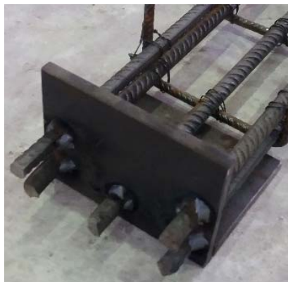
Rys. 2.1. Zakotwienie prętów GFRP (po lewej stronie) oraz stalowych (po prawej stronie) Fig. 2.1. Anchorage of GFRP (left) and steel bars (right)
