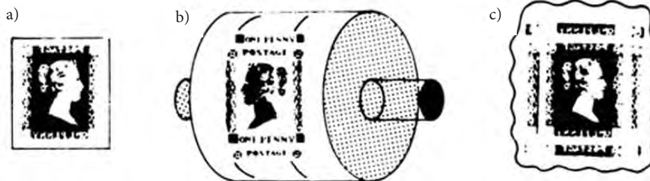
Rys. 3.41. Schemat wykonania formy stalorytniczej metodą moletowania: a) płytkę oryginalną, b) moletkę, c) odcisk wizerunku znaczka na formie Źródło: Jakuciewicz Stefan, Franz-Josef Koensler, Mariam Szewmin. Eine Briefmarke entsteht, Reihen , Insider Verlag 1992, s. 84.
