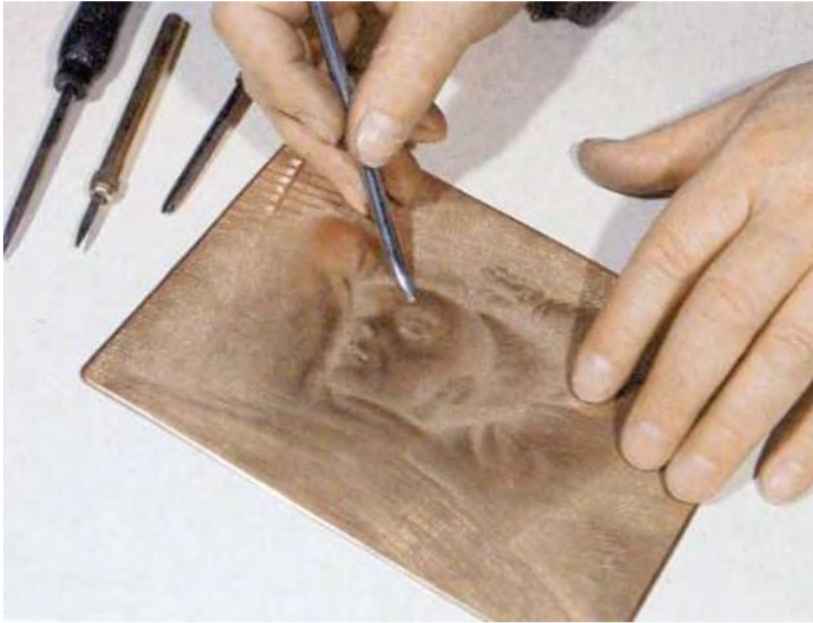
Rys. 3.52. Wykonywanie rysunku na naciętej płycie miedzianej gładzikiem
