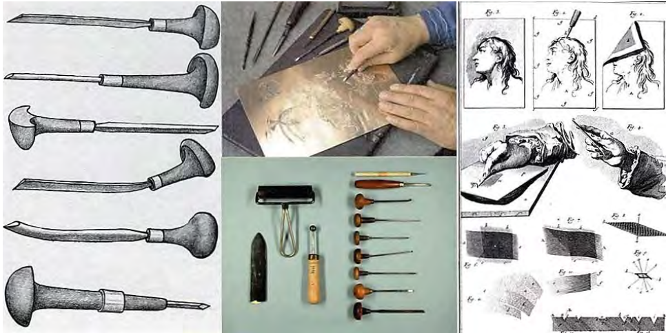
Rys. 3.9. Narzędzia do wykonywania miedziorytów oraz przebieg procesu grawerowania Źródło: Krejča Aleš, Techniki sztuk graficznych , WAiE, Warszawa 1984, s. 72, http://www.art-navigator.com/europe/austria/graphic/technik/kupferstich.jpg , https://lh3.googleusercontent.com/1o1j5yWrL9DZ_CZxeVO_QpW0kEYODYkO6zz2cjz5K3bVsLz2UHMbyoB-MlmZOxJoZThoeqg6KDXk5GgmYwVytmAL6ifsafN8SIHbDDqAYWkq2ZcTKVY , https://upload.wikimedia.org/wikipedia/commons/1/18/Herstellung-eines-Kupferstichs.png (dostęp z dnia 06.01.2016).
