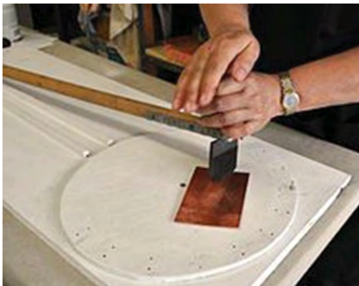
Rys. 3.51. Nacinanie płyty miedzianej chwiejakiem z dźwignią
