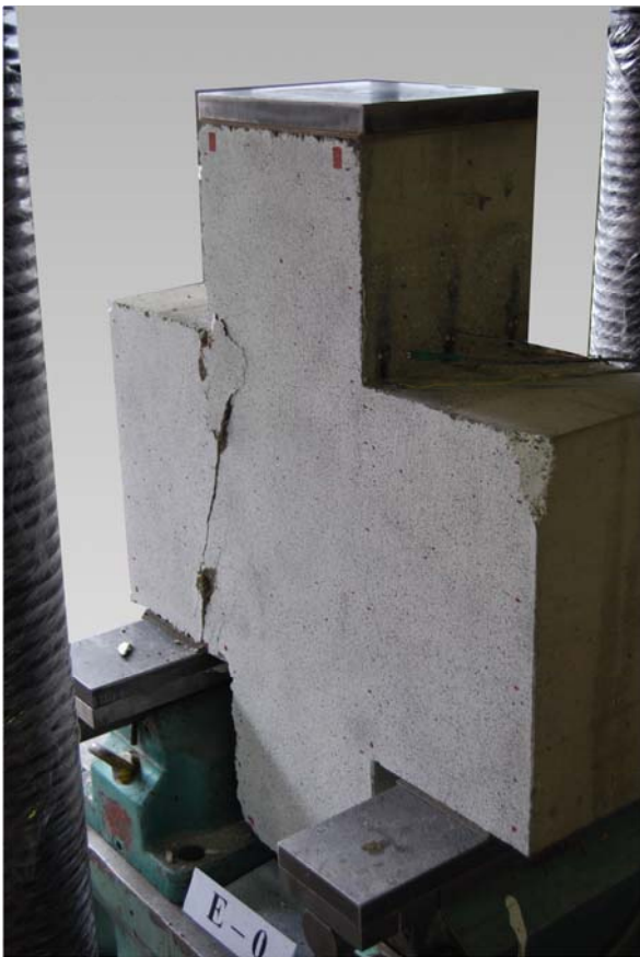
Wspornik po zniszczeniu w stanowisku / Corbel after failure in the test setup
