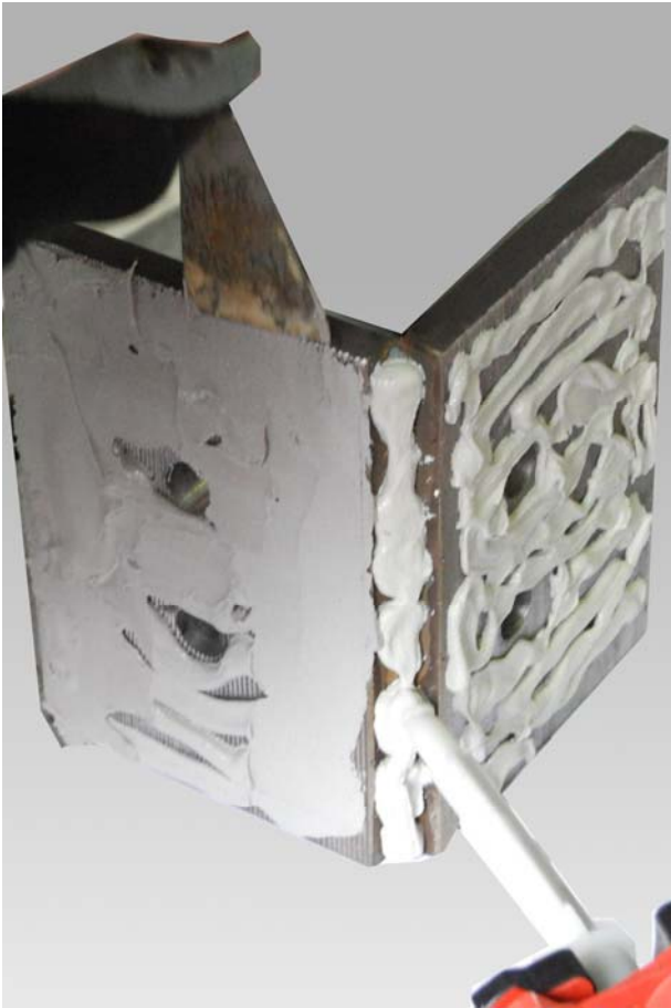
Nakładanie kleju na akcesorium Placing of the glue on accessory
