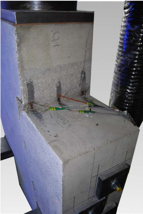
Powierzchnia boczna po zniszczeniu Side surface after failure
