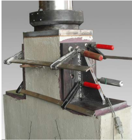
Wiązanie żywicy Curing of the resin
