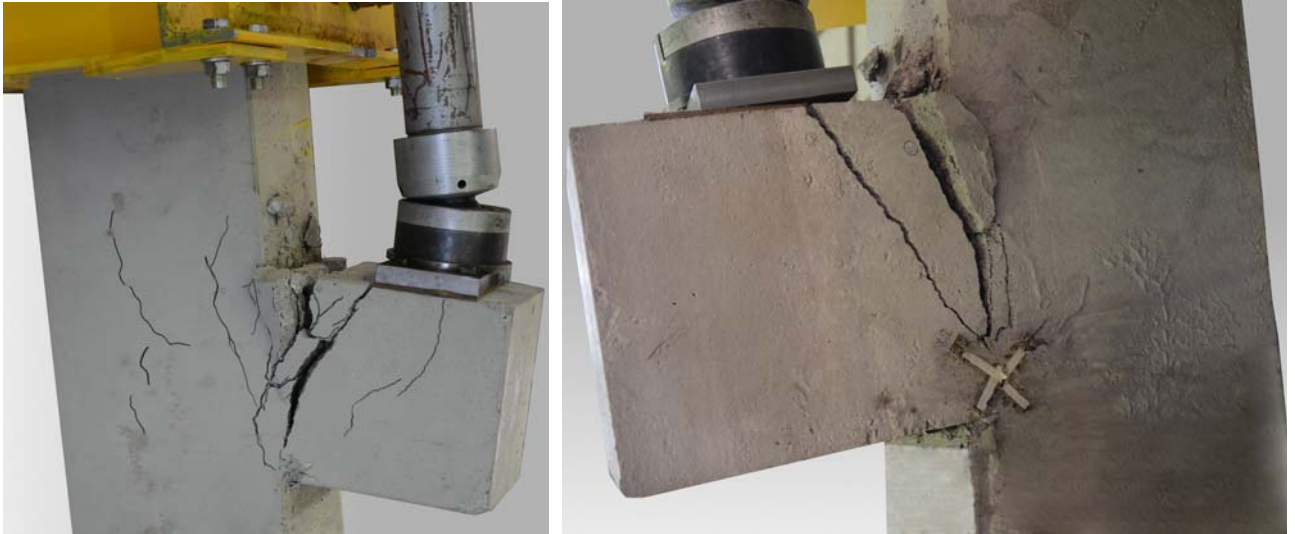
Wspornik po zniszczeniu w stanowisku badawczym / Corbel after failure in test setup
