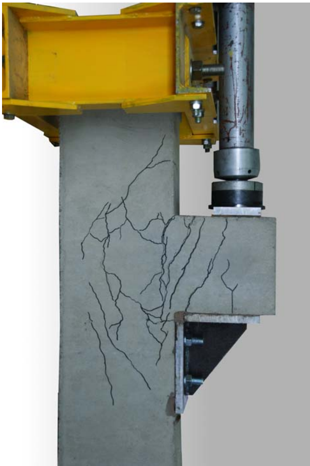
Wspornik po zniszczeniu w stanowisku badawczym / Corbel after failure in test setup
