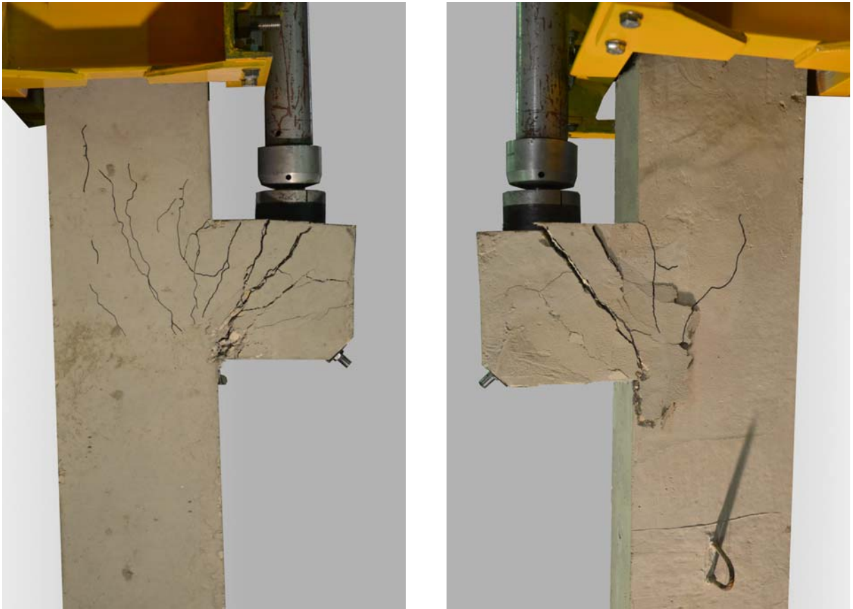
Wspornik po zniszczeniu w stanowisku badawczym / Corbel after failure in test setup
