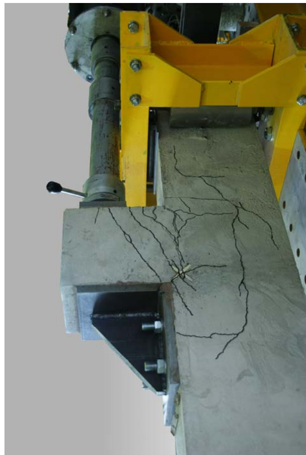
Wspornik po zniszczeniu w stanowisku badawczym / Corbel after failure in test setup
