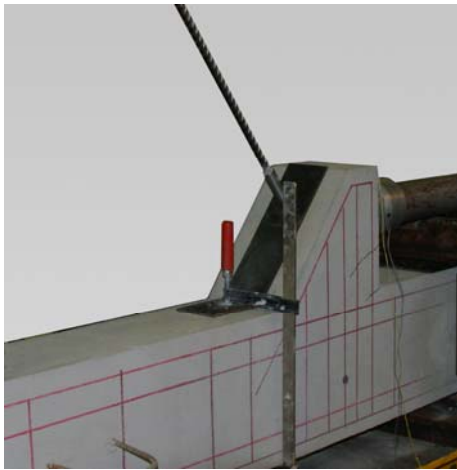
Rys. 3.4. Wiercenie otworu z wykorzystaniem urządzenia zapewniającego projektowane położenie pręta wzmocniającego po jego wklejeniu Fig. 3.4. Drilling hole using device providing designed location of rod after its embedded
