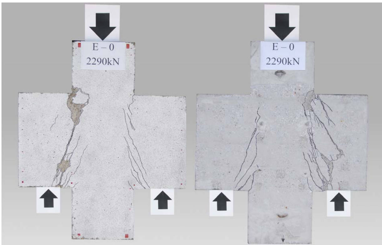
Wspornik po zniszczeniu / Corbel after failure
