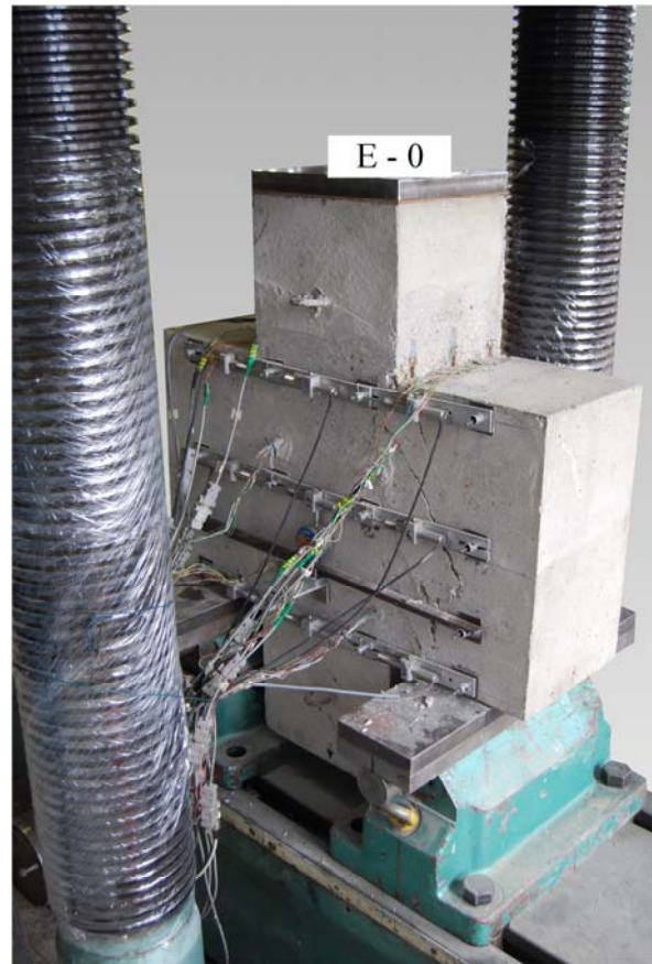
Wspornik po zniszczeniu w stanowisku / Corbel after failure in the test setup
