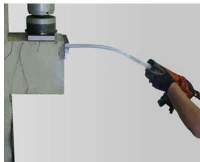
Rys. 3.6. Aplikacja kleju żywicznego Fig. 3.6. Application of resin
