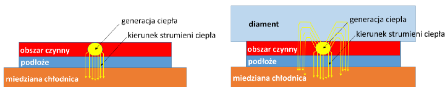
Rys. 3.4. Schematyczne przedstawienie mechanizmu odprowadzania ciepła z obszaru czynnego lasera bez i z diamentowym rozpraszaczem ciepła
