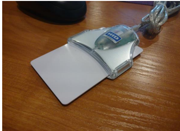
Rys. 20. Użyte urządzenia – karta JCOP J2A040 oraz czytnik HID Omnikey 3021 (źródło: własne)
