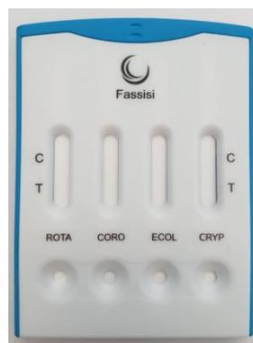
**Abbildung 3-9:** Kassette für ein Multi-Parameter-Lateral Flow Assay-System von der Firma Fassisi GmbH. Die Probe wird jeweils in den runden Aufgabefeldern aufgetragen. Das Ergebnis kann anschließend durch eine eventuelle Rotfärbung in den länglichen Feldern unter T (Testzone) und C (Kontrollzone) abgelesen werden.
