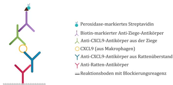
**Abbildung 4-47: Schematische Darstellung des ELISA-Aufbaus zur Untersuchung der Rattenüberstände auf ihre Fähigkeit als Fängerantikörper.**
