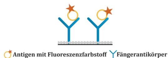
**Abbildung 4-6: Schematische Darstellung eines Microarrays im Forward-Format.**
