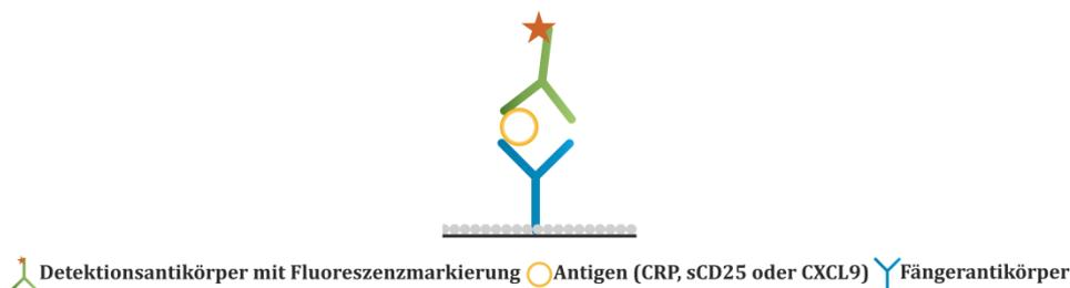
**Abbildung 4-3: Schematische Darstellung eines Microarray-Aufbaus mit Fängerantikörper, Antigen (CRP, sCD25 oder CXCL9) und einem fluoreszenzmarkierten Detektionsantikörper.**
