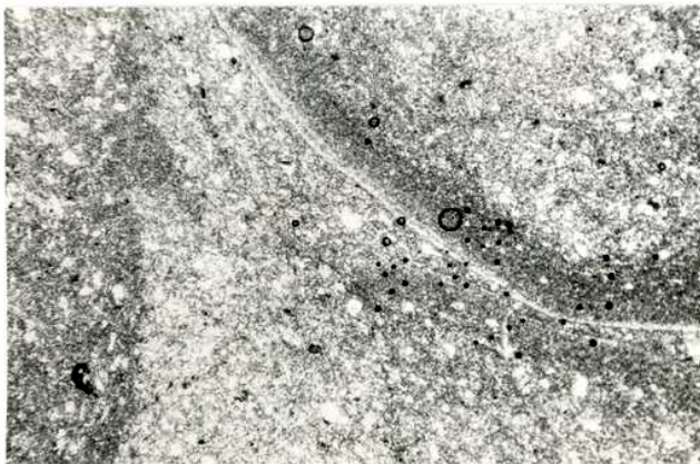
FOTOMICROGRAFIA N° 10. Toba pisolítica. Se distinguen partes de tres pisolitas volcánicas o chalazolita, dispuestas en una matriz fina de igual composición que el material que constituye las pisolitas. El diámetro de estas estructuras es 0,7 mm aproximadamente. Formación Lago La Plata, arroyo Fragua. Corte N° 250. Nícoles paralelos.
