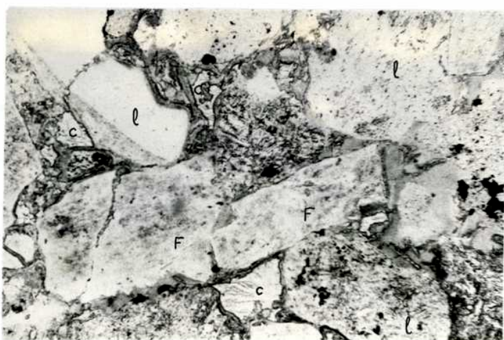
FOTOMICROGRAFIA N° 3. Arenisca lítica tobácea. Cristales idiomorfos de feldspatos (F) y fragmentos líticos angulosos, principalmente de vulcanitas ácidas (l). El cemento (c) está compuesto esencialmente por ceolita. Los cristales de feldspato miden aproximadamente 0,5 milímetros. Formación Lago La Plata, Corte N° 318. Nícoles paralelos.
