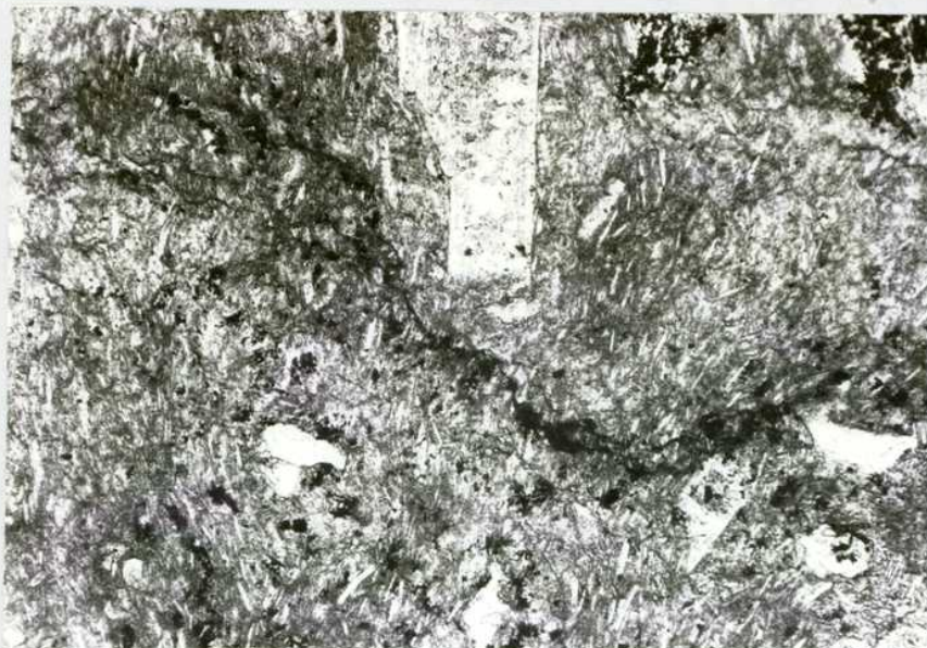
FOTOMICROGRAFIA N° 1. Queratófiro. Fenocristales de albita dispuestos en una pasta abundante, de textura fluidal, compuesta por tablillas de la misma plagioclasa y clorita. Formación Lago La Plata, Puesto Cotidiano. Corte N° 053. El fenocristal mayor de albita mide aproximadamente 1,5 mm de longitud. Nícoles paralelos.
