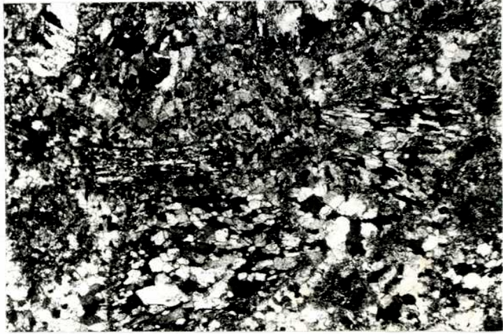
FOTOMICROGRAFIA N° 9. Toba vítrea alterada. Formación Lago La Plata, arroyo Fragua. Corte N° 248-1.
