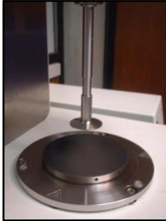
Fig. 2.9: Reómetro Para Physica MCR 300 con sistema de platos paralelos (PP30/S).
