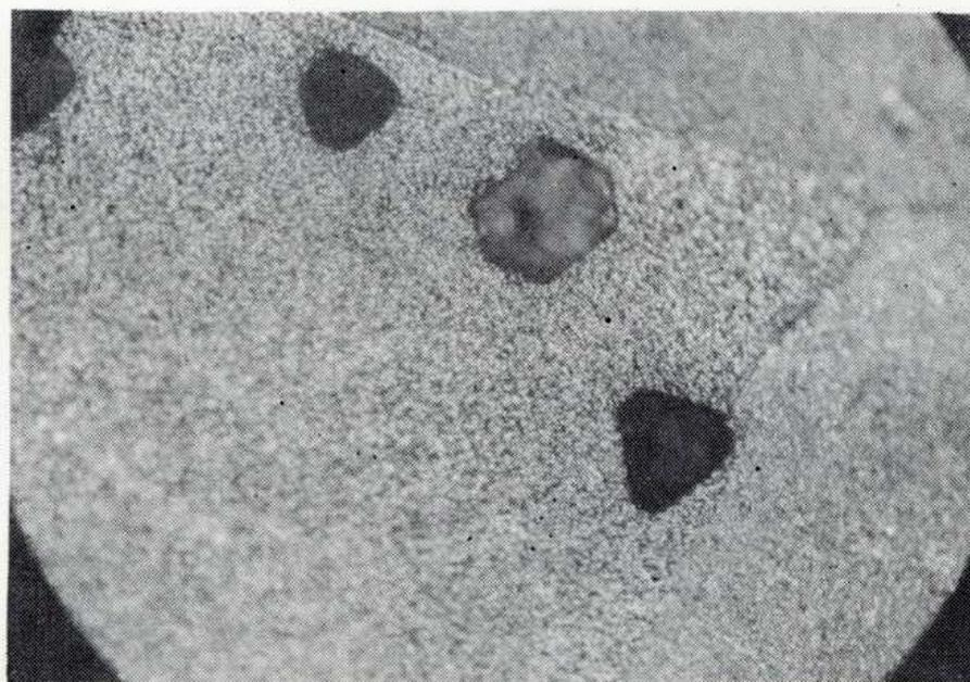
FIG.80. Ataque del hierro en solución deaireada de NaCl 1,0 M, pH=3,0 (60X).
