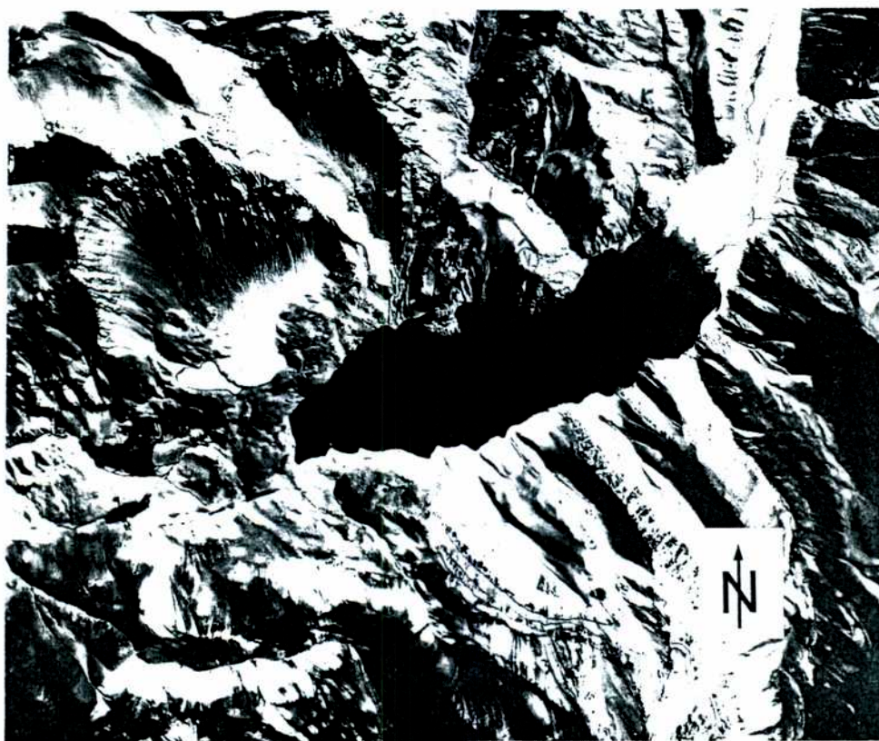
Figura 2.66: La laguna del Pelado se ubica en el sector chileno del área de estudio. Nótese al noroeste del cuerpo de agua la muesca que produjo el deslizamiento y avalancha de material que generó el cierre actual de la laguna.
