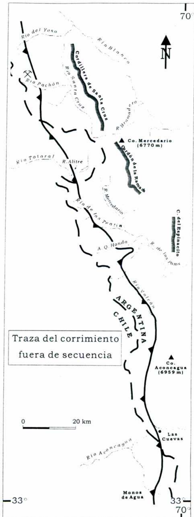
Figura 3.14: Mapa en el que se observa el extenso desarrollo del frente de corrimientos fuera de secuencia (basado en Mussini, 1989; Ramos y Aguirre Urreta, 1991; Cristallini y Cangini, 1993; Cristallini et al. , 1995).
