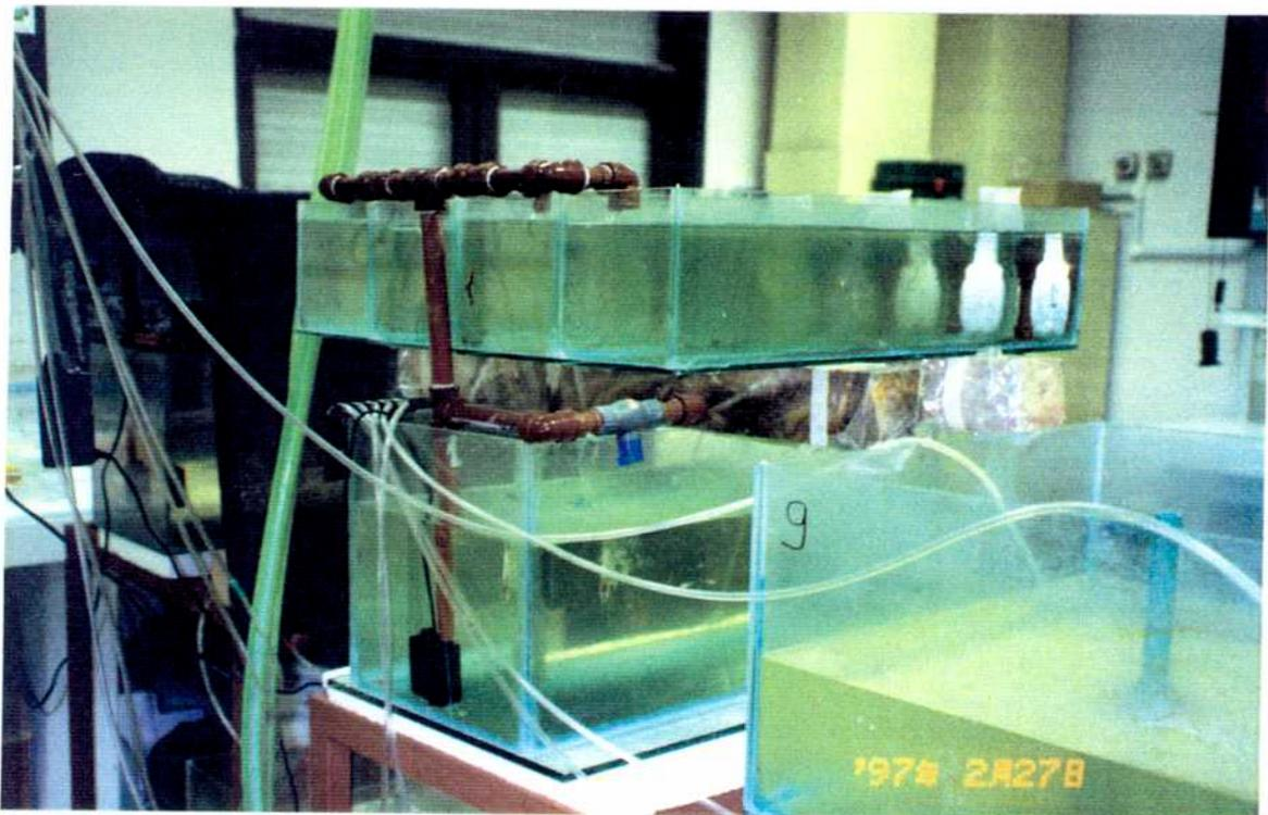
Foto 2. Vista posterior del sistema para la cría de larvas de peces. Se observa el reservorio o depósito inferior, la bomba y el sistema de recirculación en polipropileno.
